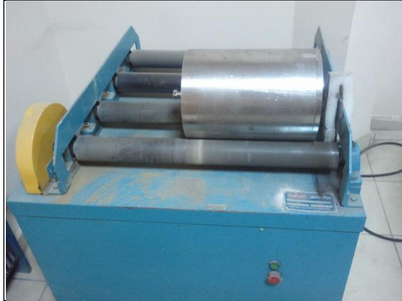
Şekil 3.1: Deneylerde kullanılan laboratuvar tipi Denver markalı bilyalı değirmen ve değirmen tahrik ünitesi
