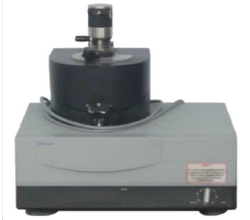
Şekil 3.2: Numune öğütmede kullanılan Retsch marka agat öğütücü
