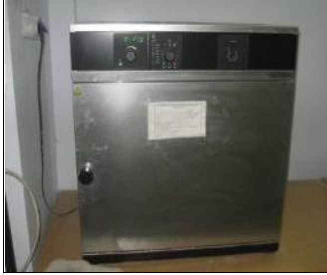
Şekil 3.3: Nem analizlerinde kullanılan Memmert ULM500 etüv
