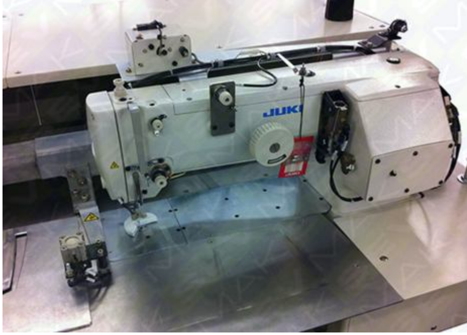
Şekil 5.14. Sanayi tipi otomatik dikiş makinesine örnek Juki tam otomatik jeans arka cep takma otomatı ( http://www.sevmak.com/urun/1515/juki-avp-875-tam-otomatik-jeans-arka-cep-takma-otomati.html )
