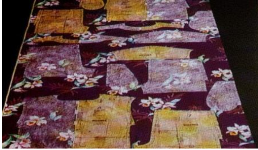
Şekil 5.25. Çiçek desenli kumaşta elde pastal yerleşim planı (MEGEP, 2006)
