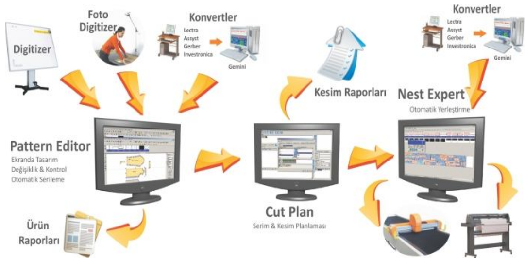
Şekil 5.19. Kalıp aşamasından kesime kadar mevcut ve olası CAD işlem akışı ( http://www.geminicad.com.tr/apparel_textile/typical_configuration_and_workflow.php )
