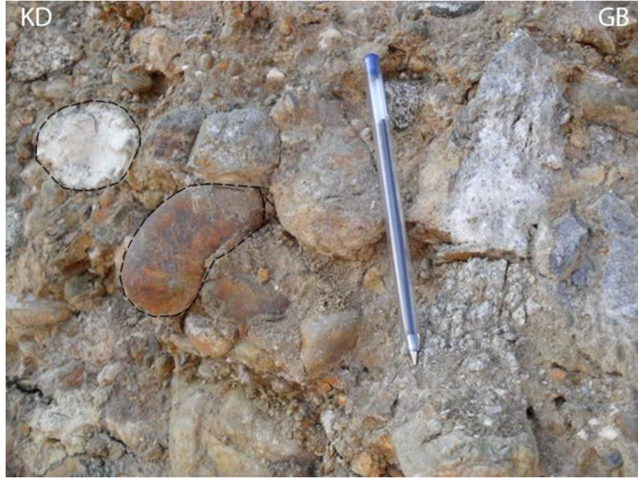
Şekil 4. 30: Çaydere yolu girişi-İlca Formasyonunda gözlenen volkanik kökenli çakıllar ve karbonat yumruları (Siyah çizgi ile konturlanmıştır).
