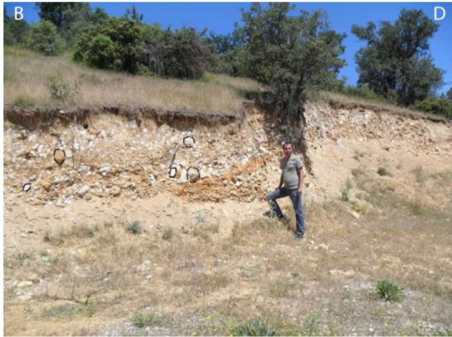
Şekil 4. 29: Köyiçi Tepe civarında gözlenen karbonat yumruları içeren (siyah çizgi ile konturlanmıştır) çakıltası birimi.
