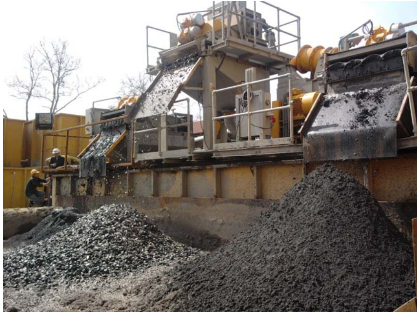
Şekil 4.9 : Diyafram duvar desender ünitesi.
