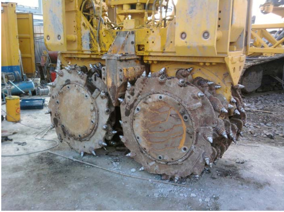
Şekil 4.8 : Diyafram duvar freze ekipmanı.
