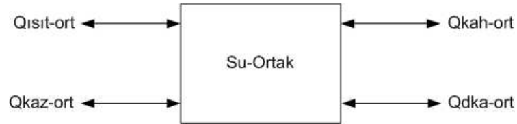
Şekil 4.5: Su-Ortak Kontrol Hacmine Ait Isıl Denge Şeması
