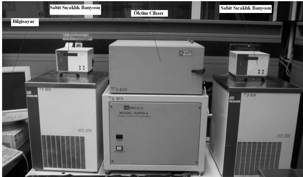
Şekil 3.11: 300x300 mm. Boyutlarında Ölçüm Yapabilen Isı İletim Katsayısı Ölçüm Cihazı
