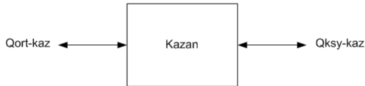
Şekil 4.6: Kazan Kontrol Hacmine Ait Isıl Denge Şeması
