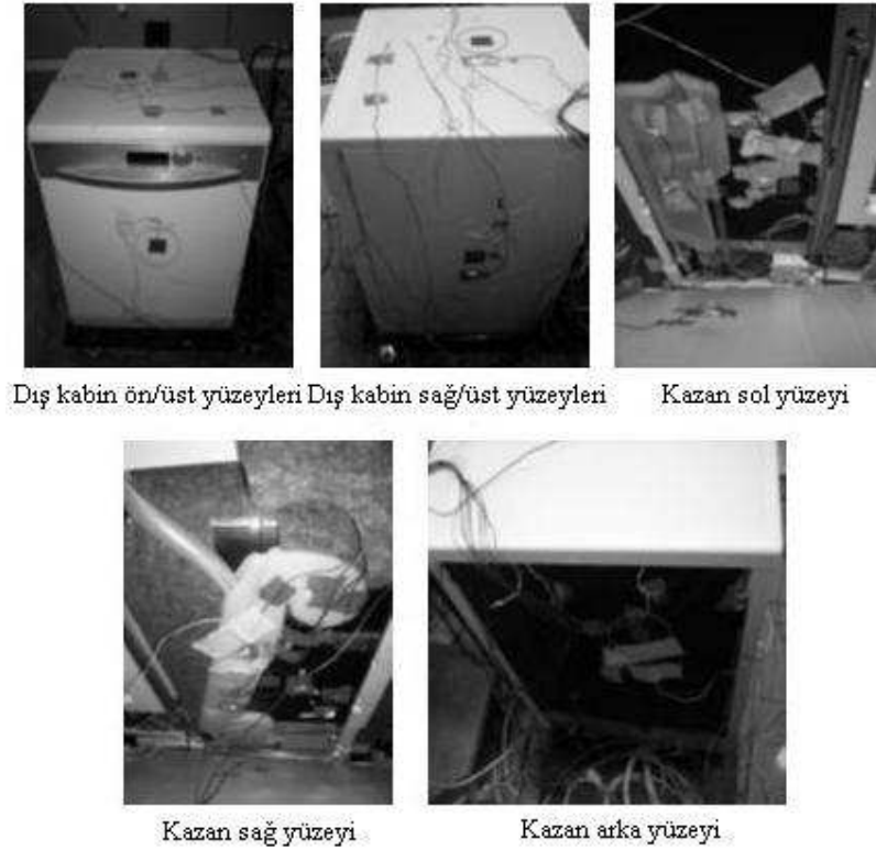
Şekil 3.21: Bulaşık Makinesi Isı Akısı Sensörleri Yerleşimi
