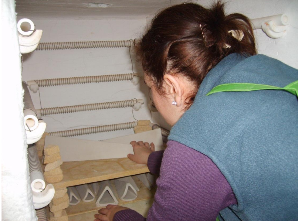
Resim 3.30. Bisküvi fırınının yerleştirilmesi.
