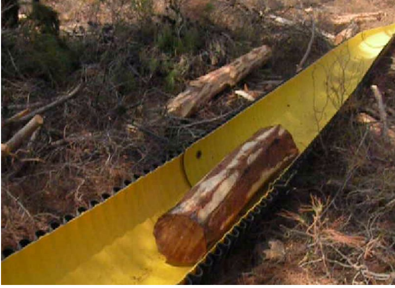
Şekil 1.5. Oluk sistemi ile yamaç aşağı bölmeden çıkarma uygulaması
