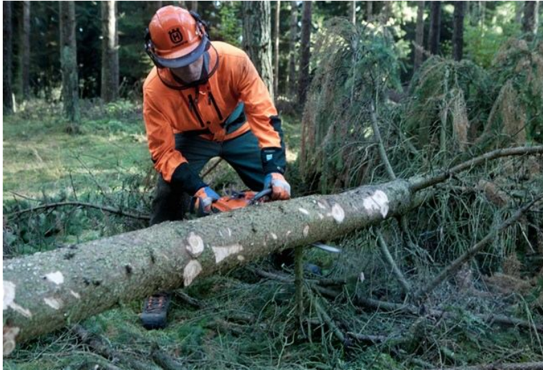
Şekil 1.2. Motorlu testere ile ağaç dallarının temizlenmesi
