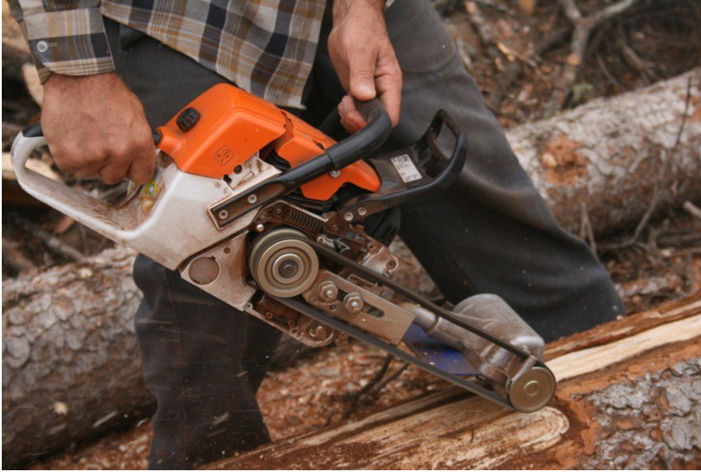
Şekil 1.3. Elle kumanda edilen kabuk soyma makineleri
