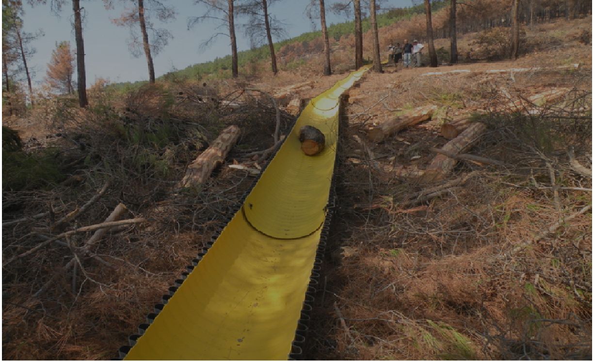
Şekil 2.5. Oluk sistemi ile taşıma sırasında hakim noktadan veri ölçümü
