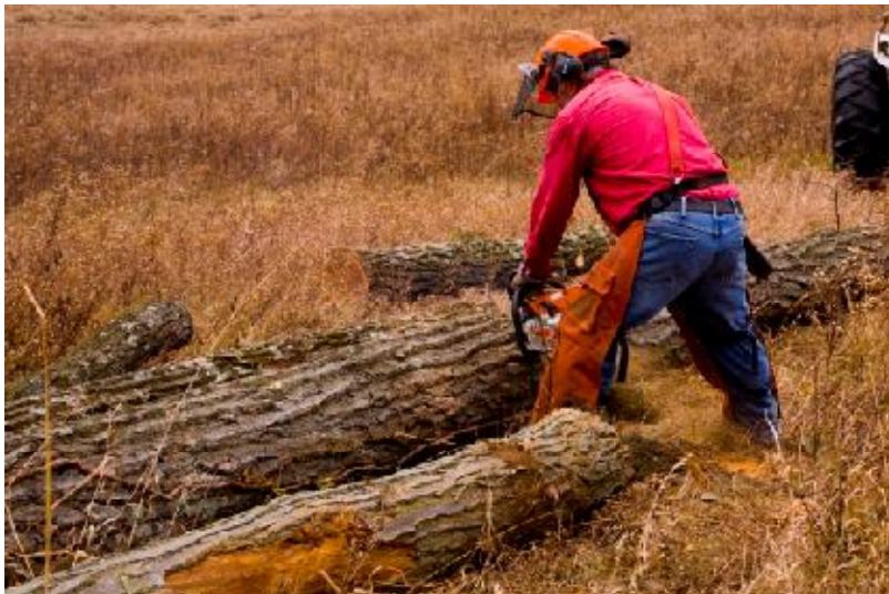
Şekil 1.4. Motorlu testere ile boylama
