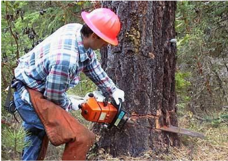
Şekil 1.1 Motorlu testere ile devirme oyuğunun açılması
