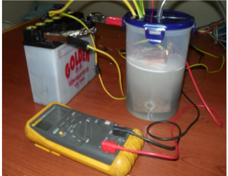
Şekil 4.3: Islak hücreli bakır plakalı üreteçten hidroksi gazı elde edilmesi.
