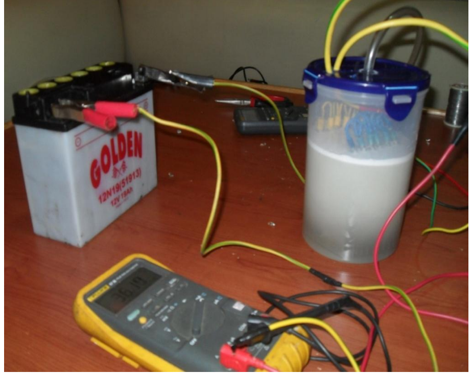
Şekil 4.2: Islak hücreli çelik plakalı üreteçten elde edilen hidroksi gazı.
