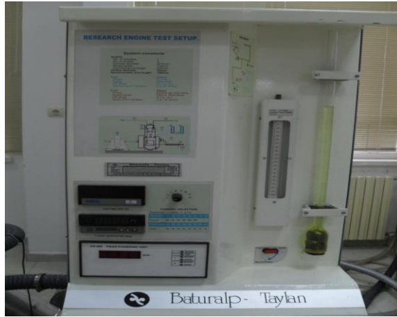
Şekil 3.22: Yakıt tüketim ölçüm cihazının genel görünümü.
