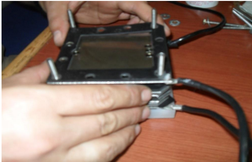
Şekil 3.13: Üretecın montaj işlemi.
