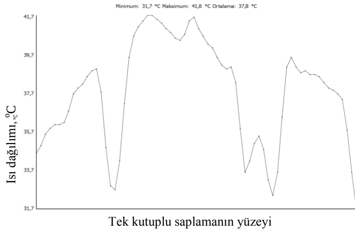
Şekil 4.18: Tek kutuplu plakanın bulunduğu saplamanın ısı dağılımı.
