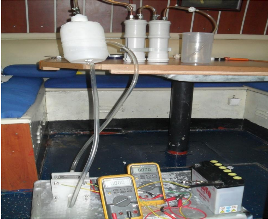
Şekil 3.17: Hidrojen üreteç sisteminin tamamlanmış hali.
