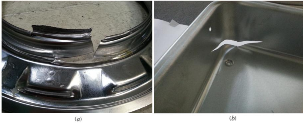
Şekil 4.1 : (a) Çamaşır makinesi tambur ön sacında oluşan kırılma örneği. (b) Fırın çekmece esas sacında oluşan kırılma örneği.
