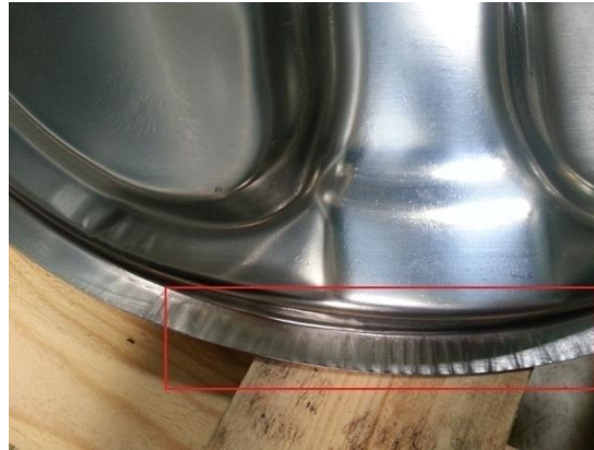
Şekil 4.2 : Çamaşır makinesi tambur arka sacında meydana gelen kırışmaya ait bir örnek.
