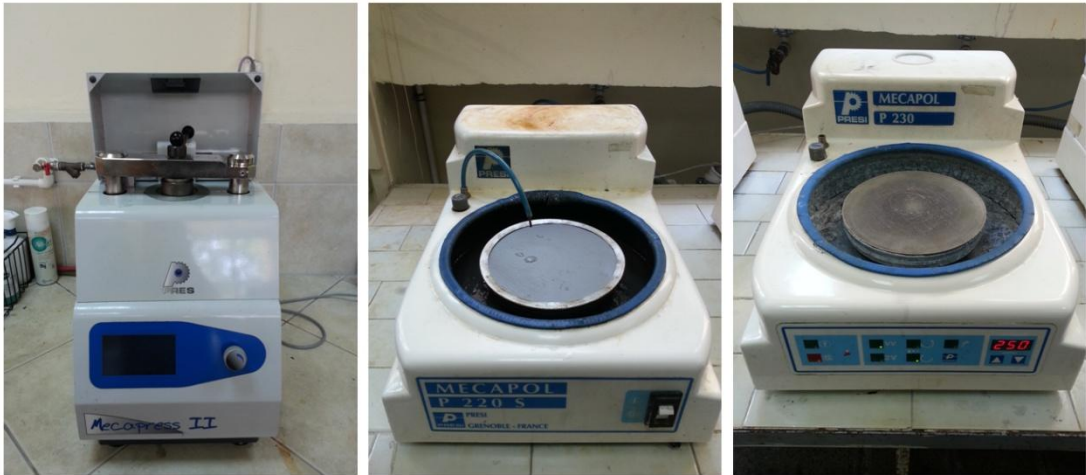
Şekil6.13 : Sırasıyla bakalite alma, zımparalama ve parlatma işlemlerinin gerçekleştirildiği cihazlar.
