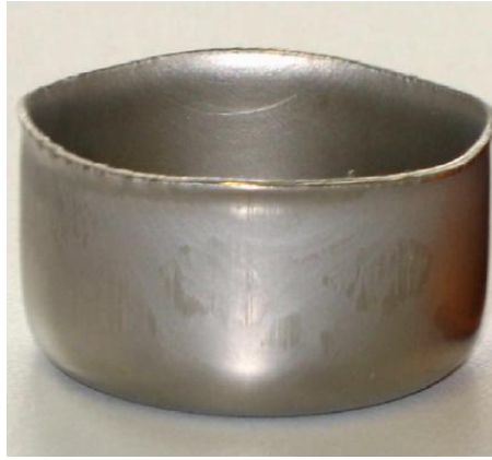
Şekil 2.6 : Kulaklanmaya ait örnek, ferritik paslanmaz çelik X6Cr17 [13].
