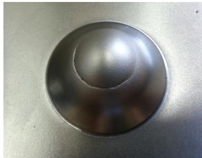
Şekil 6.10 : Erichsen çökertme testi sonucunda elde edilen numune görünümü.
