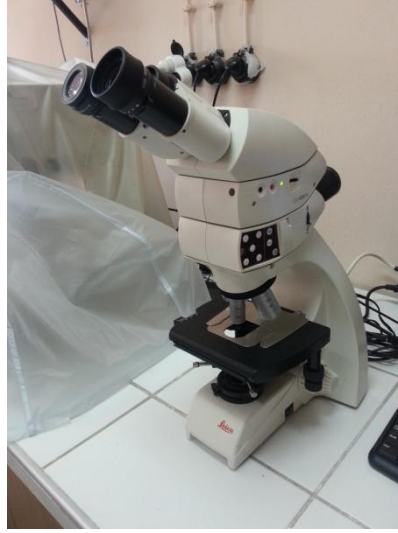
řekil 6.15 : Mikro yapı incelemelerinin gerekleřtirildiđi optik mikroskop.
