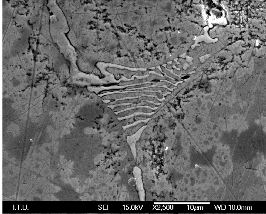
Şekil 5.39: Numunenin merkez bölgesinde bulunan ağ şeklindeki ötektik karbürün görüntüsü
