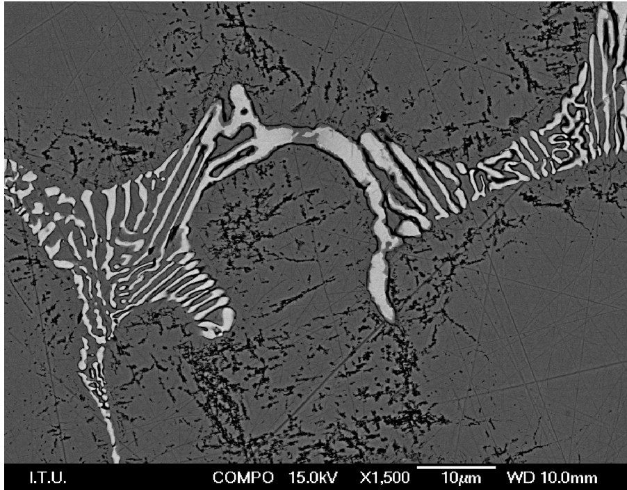
Şekil 5.35: Numunenin orta bölgesinde bulunan ağ şeklindeki ötektik karbürün görüntüsü
