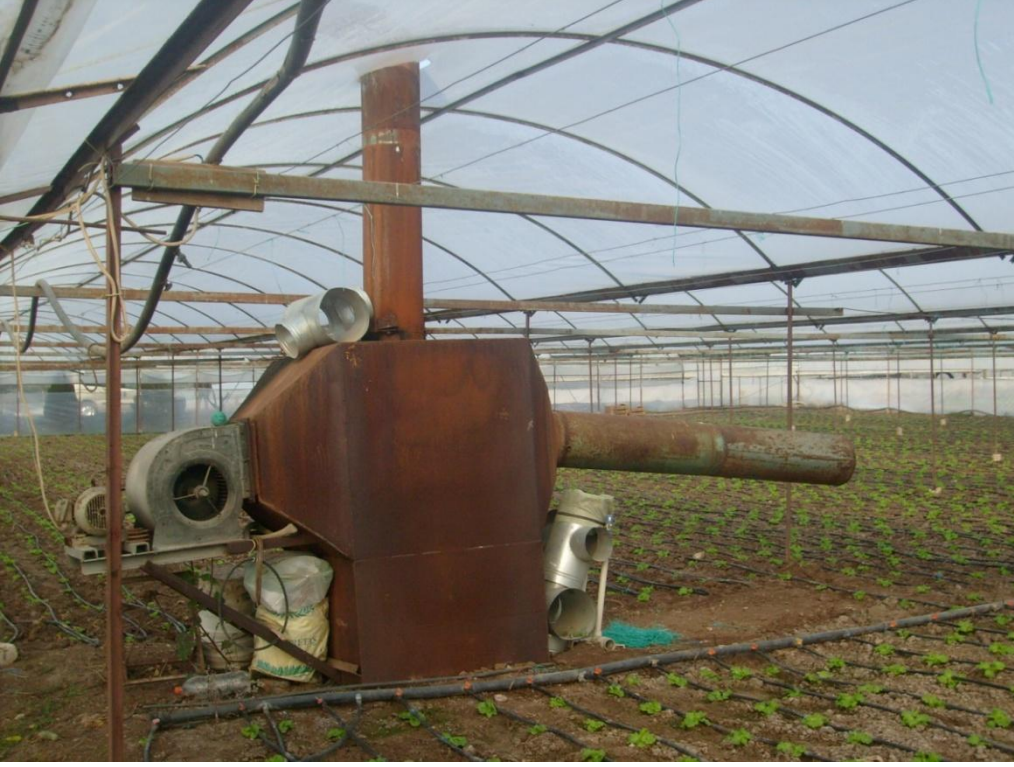
Şekil 4.28. Bir işletmeye ait serada soba ısıtma sistemi (Çamönü Köyü, Akhisar)
