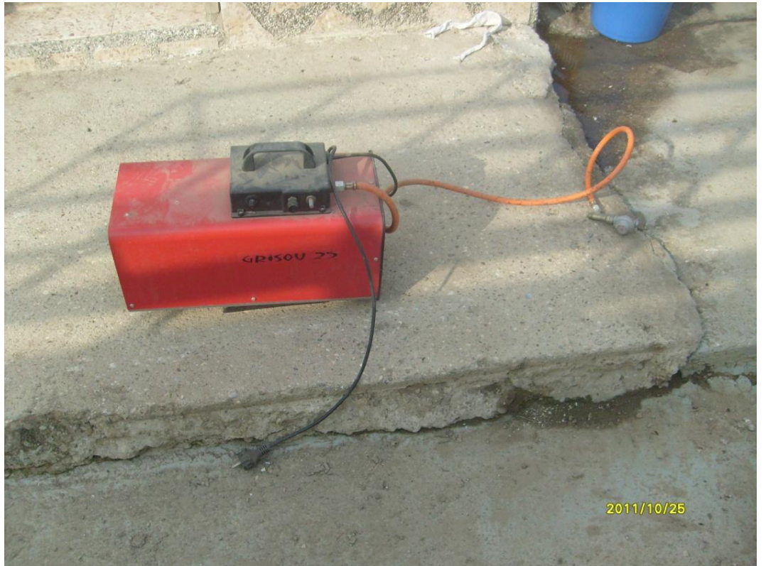
Şekil 4.30. Bir işletmeye ait seranın ısıtılmasında kullanılan elektrik ve gaz ile çalışabilen cihaz (Karaağaçlı Köyü, Manisa Merkez)
