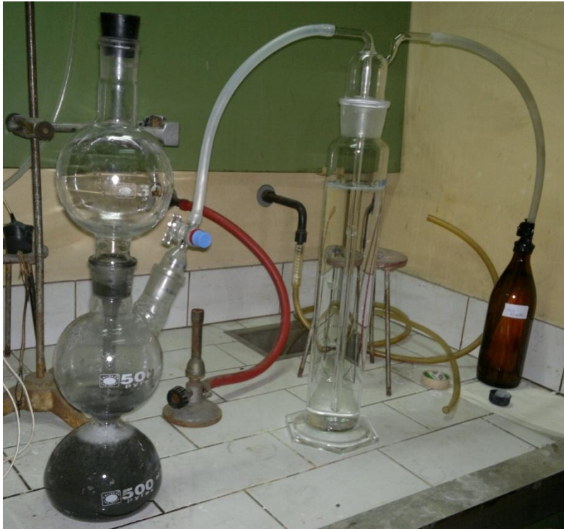
Resim 7.1. H 2 S gazının elde edilmesinin deney düzeneği
