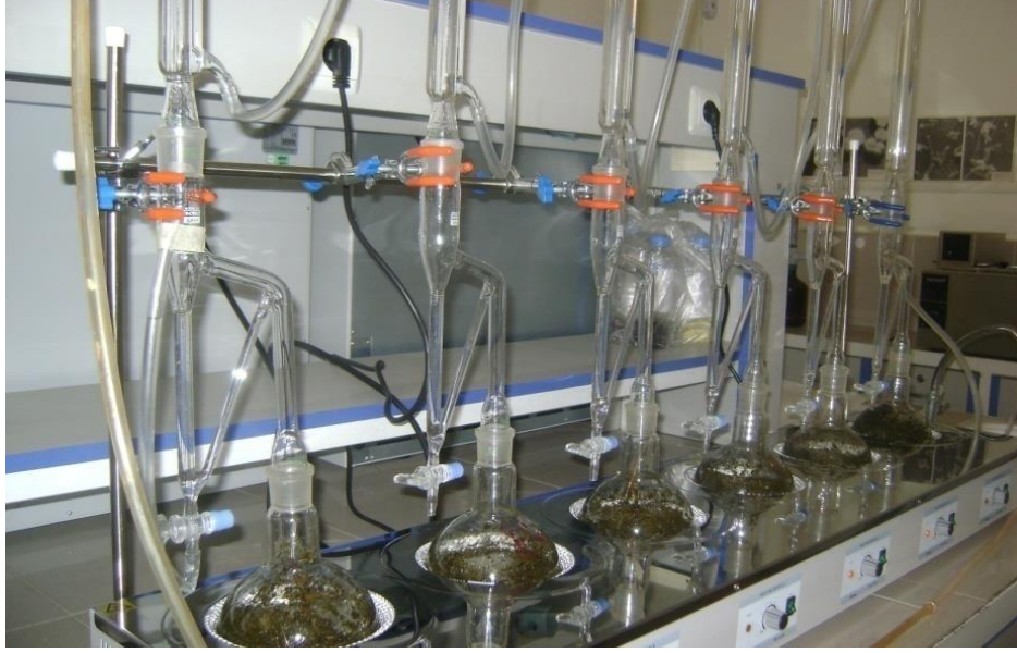
Şekil 3.5.2.1.1. Uçucu yağların elde edilmesinde kullanılan su buharı distilasyon cihazı
