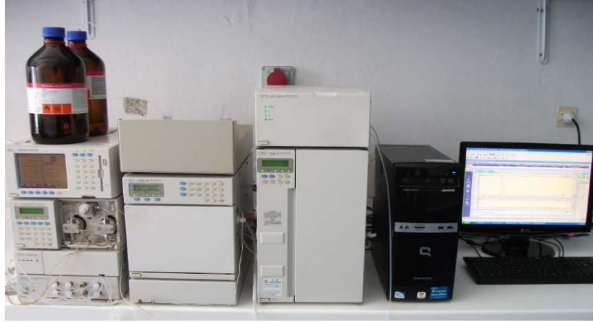
Şekil 3.6. Fenolik bileşiklerin analizinde kullanılan Yüksek Performanslı Sıvı Kromatografisi cihazı
