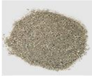
Şekil 3. 1. Karışımlarda kullanılan 0-4 mm dane aralığındaki pomzanın görünümü
