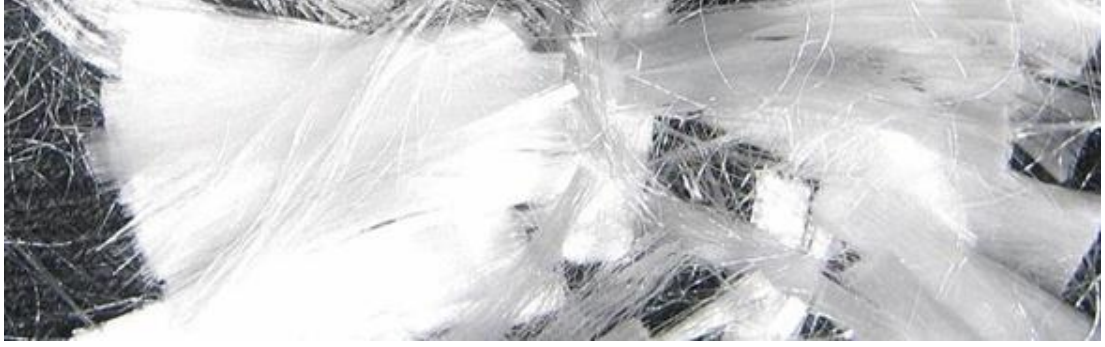
Şekil 3. 5. Karışımlarda kullanılan polipropilen liflerin görünümü
