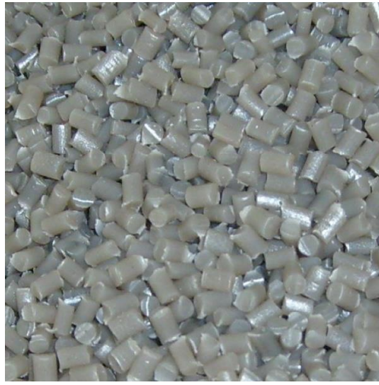
Şekil 3. 4. Karışımlarda kullanılan granüle plastik atığının görünümü
