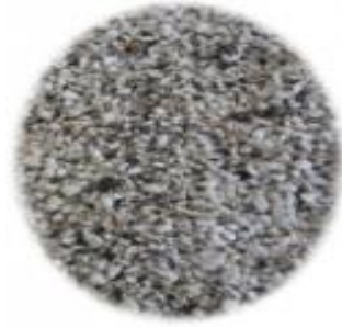
Şekil 3. 1. Karışımlarda kullanılan 0-4 mm dane aralığındaki pomzanın görünümü
