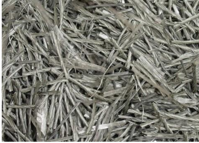
Şekil 3. 6. Karışımlarda kullanılan sentetik makro fiber donatı lifin görünümü
