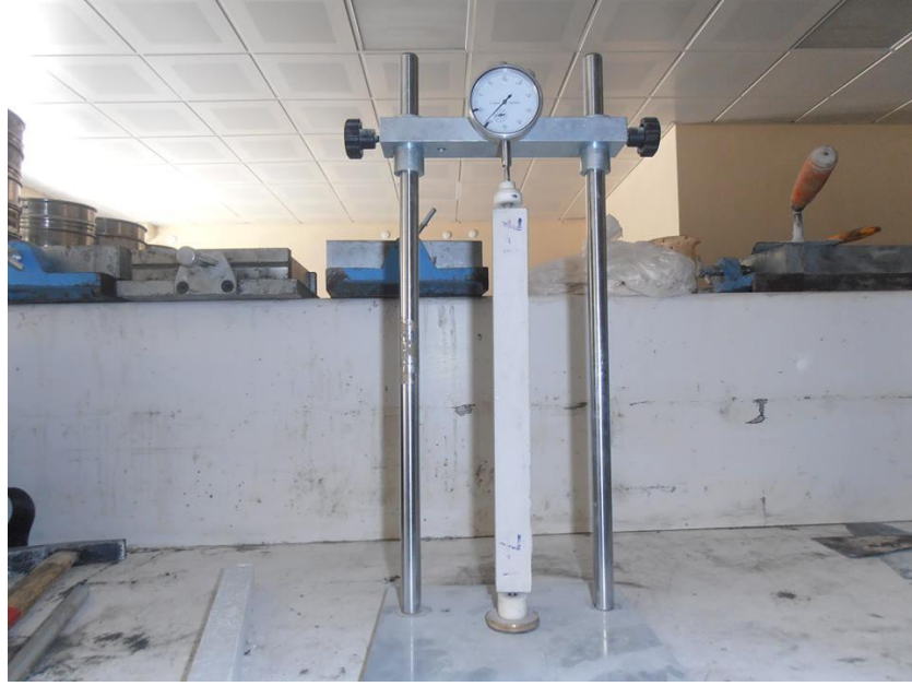
Şekil 4. 25. Rötre ölçümlerinin yapıldığı deney komparatörü
