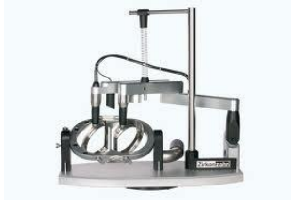
Resim 15. Zirkonzahn manuel freze ünitesi
