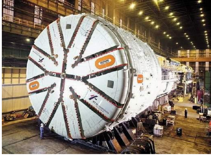
Şekil 4.1 : Tünel açma makinesi (TBM/TAM).
