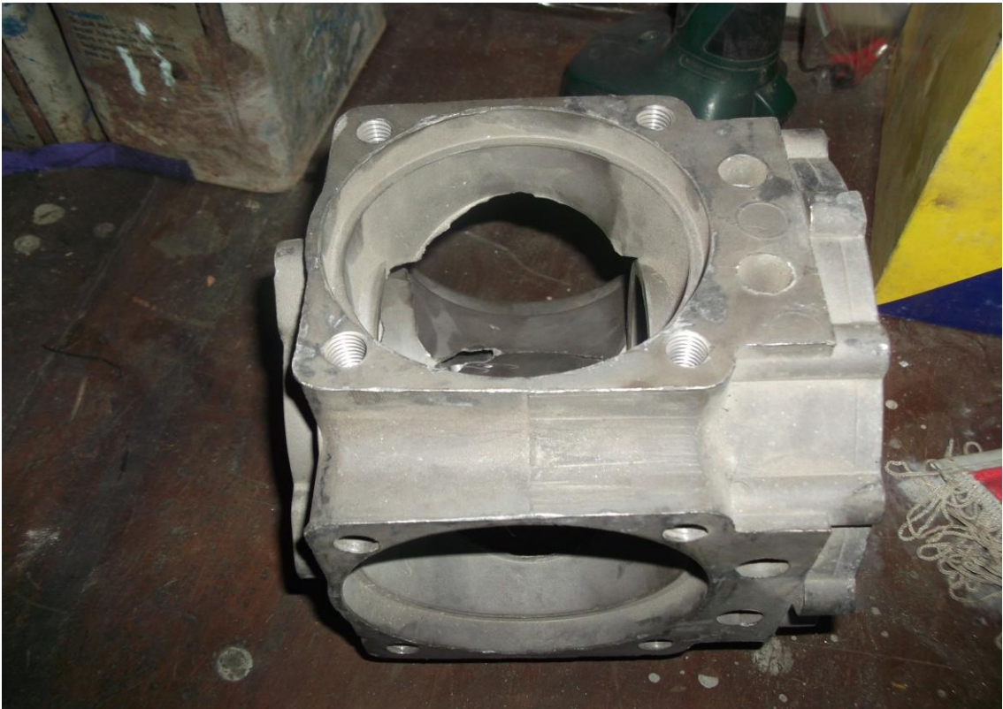
Şekil.4.14. Pompa gövdesinde görülen kırılma.
