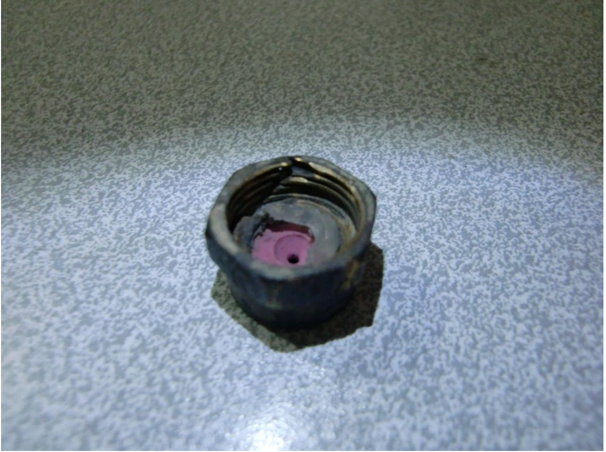
Şekil.4.15. Püskürtme memesinde ilaçlı sıvının contada ve püskürtme memesi başlığındaki etkisi.
