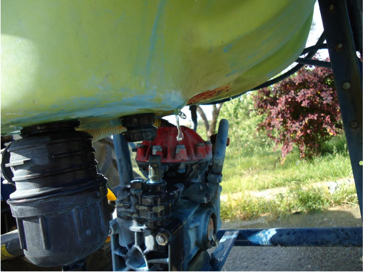
Şekil.4.13. İlaçlama makinesi deposunda kırılmadan kaynaklanan ilaçlı su sızıntısı.
