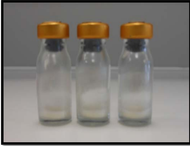
Resim 3.4. Liyofilizasyon sonrası toz haline getirilen vial içindeki EPS'ler
