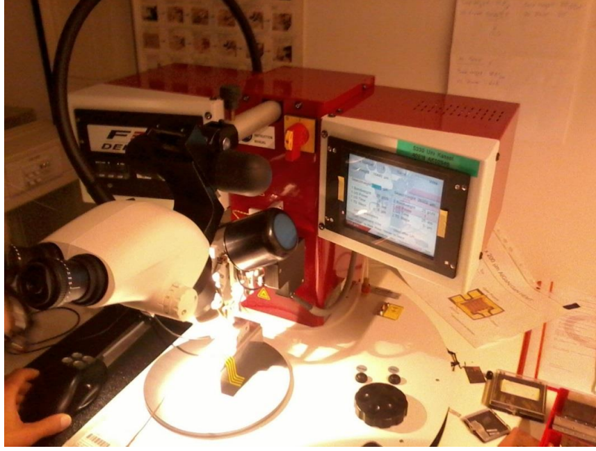
Şekil 3.16. Anten üzerine bond wires eklenmesi (Bonding Machine - Bonder 5330 F8E Deluotcc Branau – Germany, 2006)
