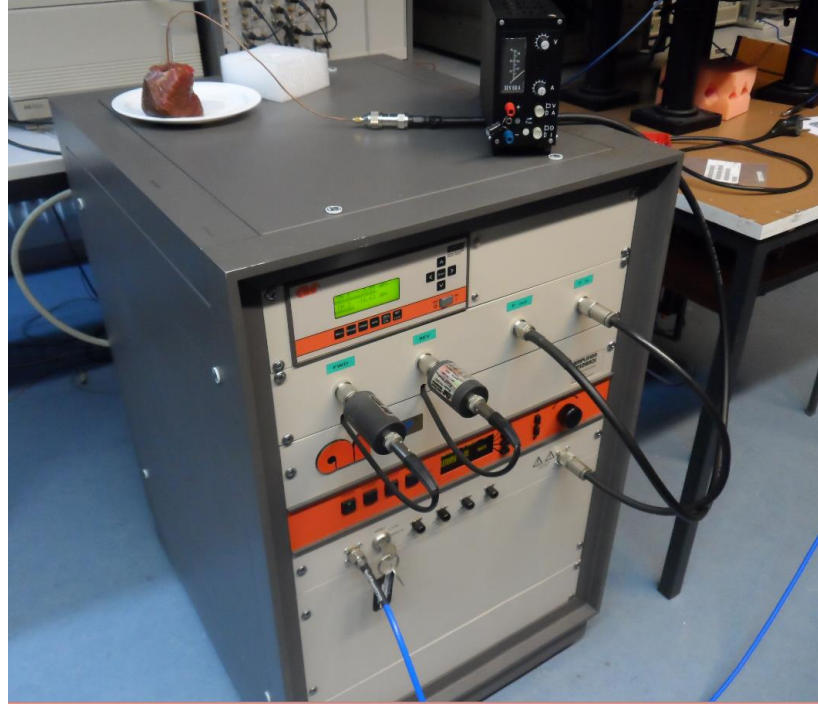
Şekil 3.18. 100W CW güç yükselteci (0.8 - 4.2 GHz, Amplifier Research, Germany, 2003)
