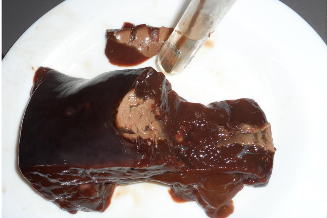
Şekil 4.7. Biyoimplant anten ile mikrodalga ablasyon uygulaması (3.55 GHz, 80 W güç, 50 saniye uygulama süresi)
