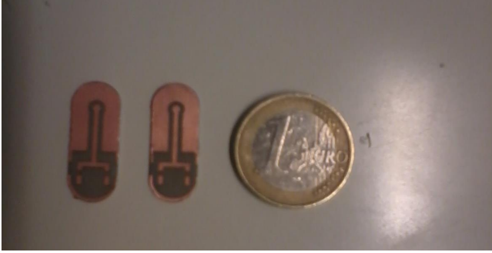
Şekil 3.14. Antenlerin üretim sonrası boyut karşılaştırması
