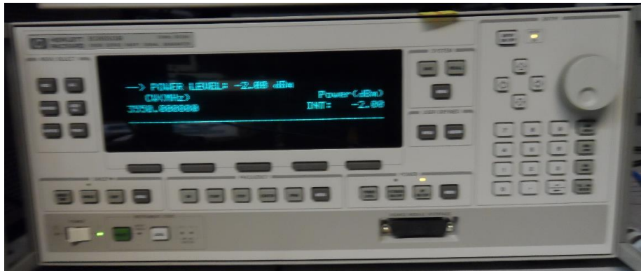
Şekil 3.19. 50 GHz sinyal jeneratörü HP 83650B (10 MHz - 50 GHz, Germany, 2003)
