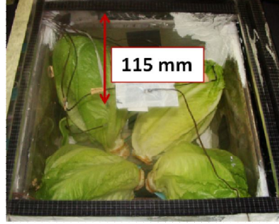
Şekil 4.17 : Marul yüzeyi ile tavan yüzeyi arasında kalan mesafe.
