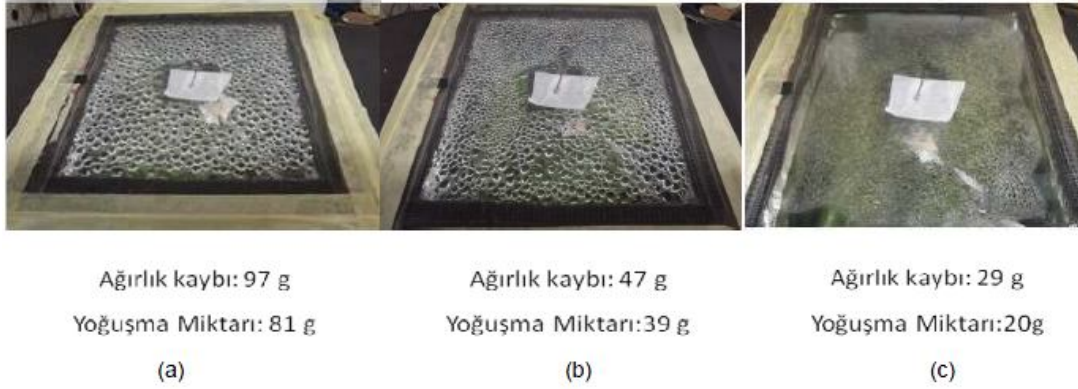
Şekil 4.10: Tavan yüzeyindeki yoğuşmanın \Delta T ’ ye bağlı değişimi (a) \Delta T=5,5K , (b) \Delta T=2,4K , (c) \Delta T=0,9K .
