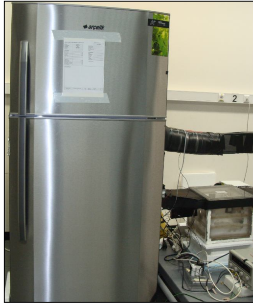
Şekil 3.8 : Deney düzeneğinde kullanılan iki kapılı no-frost buzdolabı kabini.
