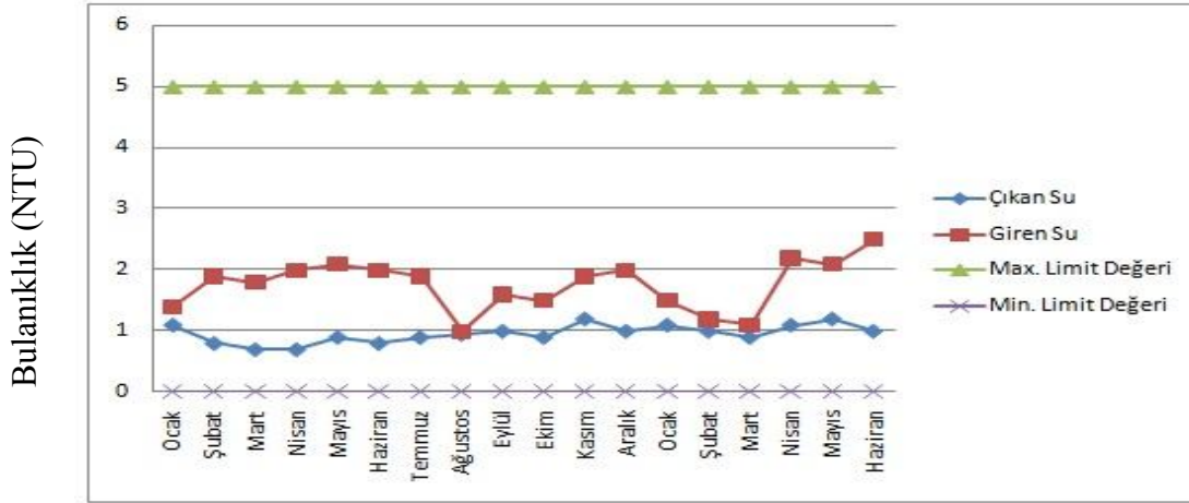
Şekil 6.2. Kahramanmaraş İçme Suyu Arıtma Tesisi Giriş ve Çıkış Bulanıklığının Aylara Göre Değişimi.
