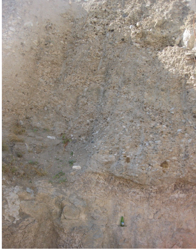
Foto 4 İnceleme Sahasındaki Asi Nehri'ne Ait Akarsu Taraçası Çökelleri (Antakya Belediyesi Yaşam Merkezi İnşaatı Temel Kazısı, Meydan Mahallesi)
