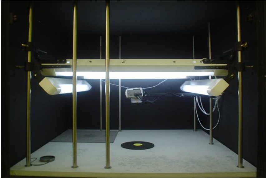
Şekil 1.28 : Patates cipsi görüntü alma düzeneği [29].
