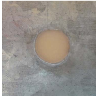
Şekil 3.5.1. Metal kalıp içindeki kompozit örneği
