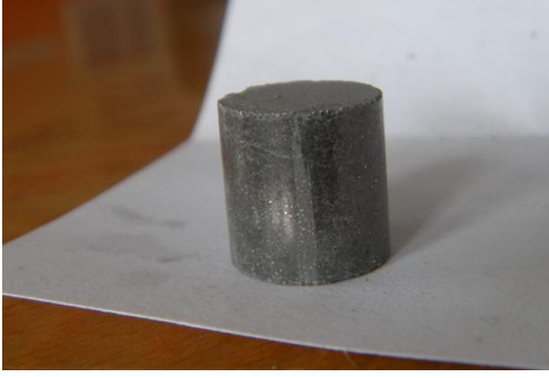
Şekil 4. 3. Preslenmiş, sinterlemeye hazır, hacimce %50 Mg içeren numune.
