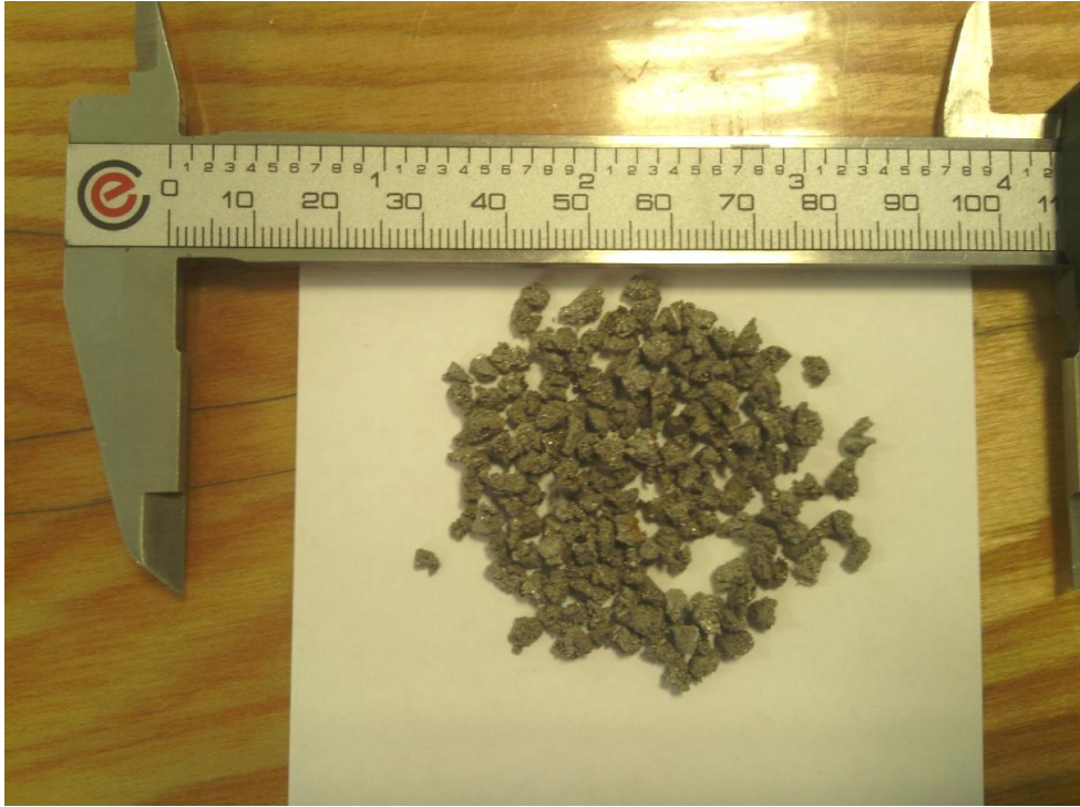
Şekil 4. 5. 3-4 mm çapında saf titanyum süngerler.
