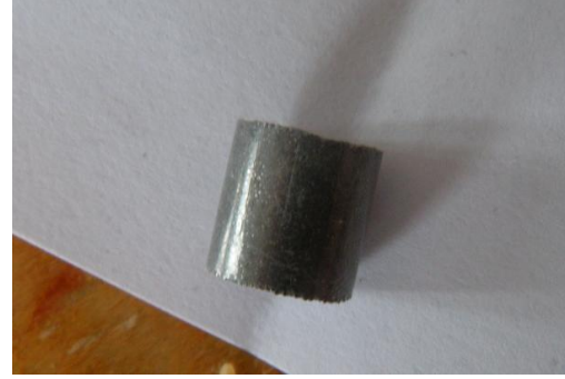
Şekil 4. 3. Preslenmiş, sinterlemeye hazır, hacimce %50 Mg içeren numune.
