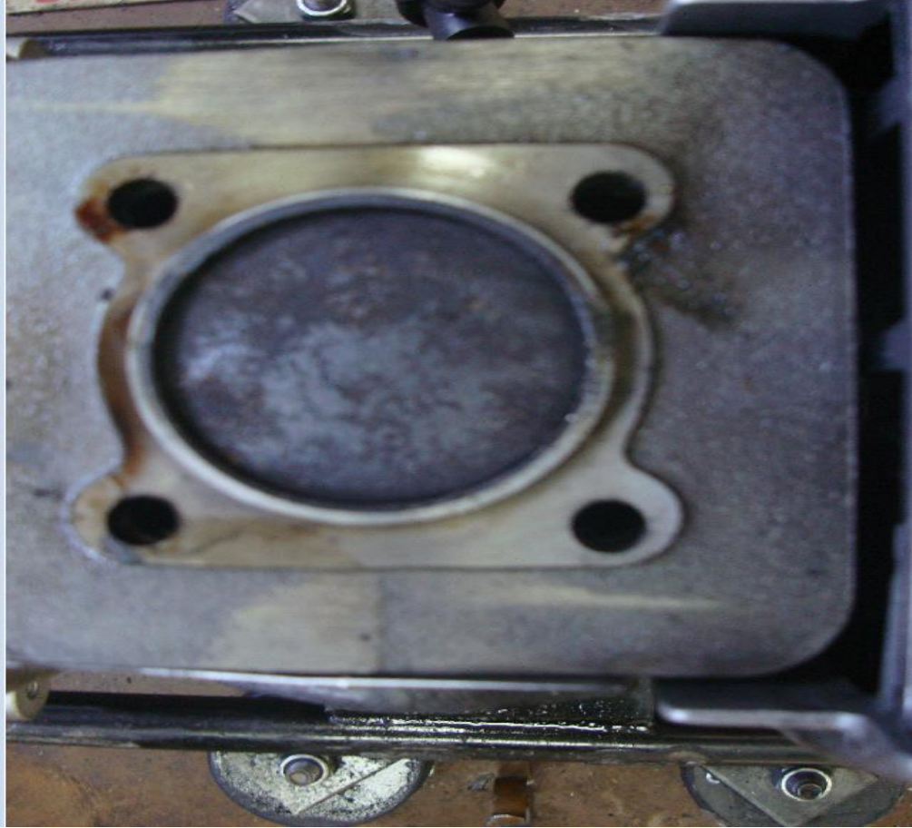
Şekil 3.4. Deney motorunun benzin-fındık yağı karışımı ile çalıştırılması sonucu piston görüntüsü
