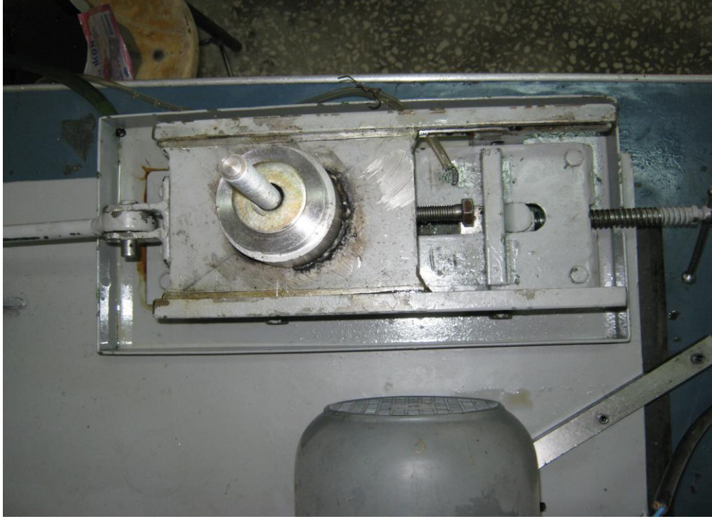
Şekil 2.8. Simülasyon test cihazında ileri-geri hareket eden sistem
