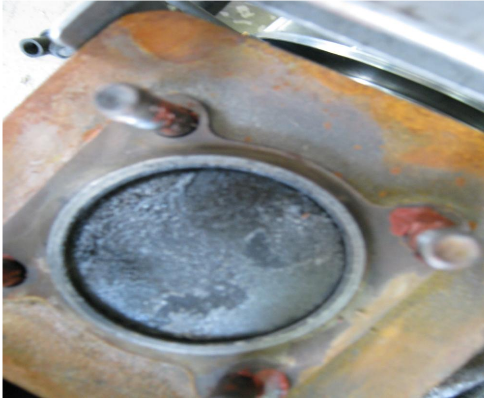
Şekil 3.3. Deney motorunun benzin-mineral yağ karışımı ile çalıştırılması sonucu piston görüntüsü
