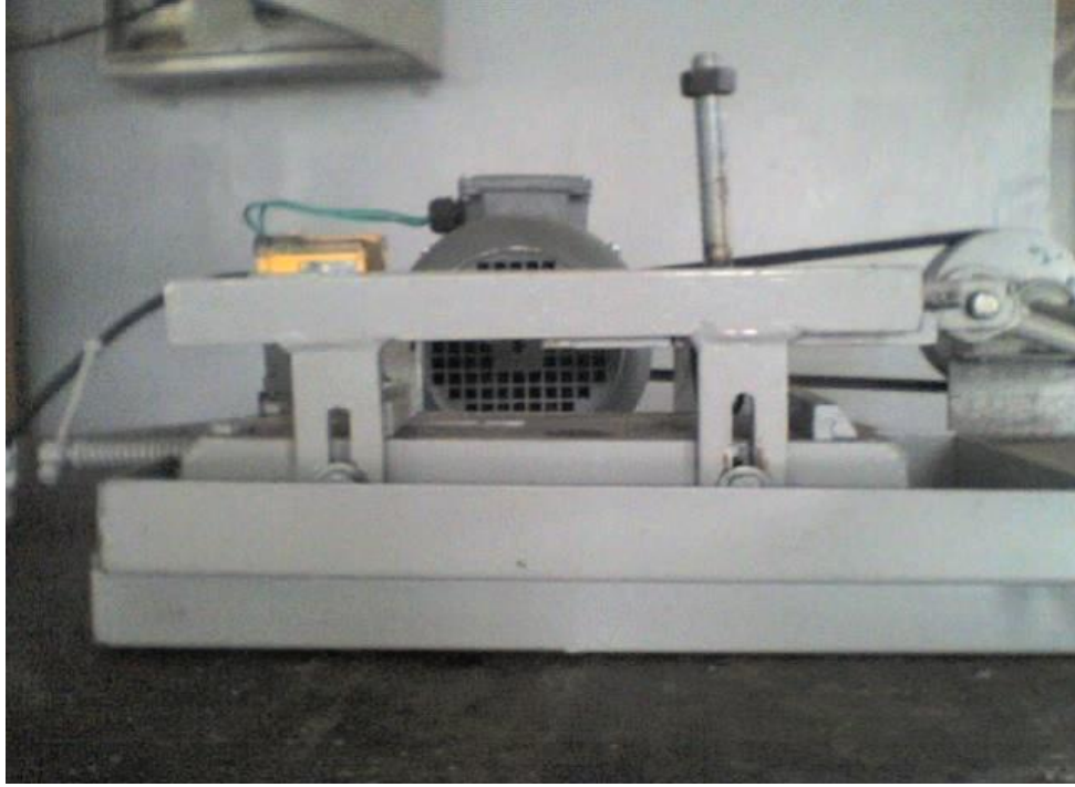
Şekil 2.6. Simülasyon test cihazında silindir numunesinin bağlanma aparatı
