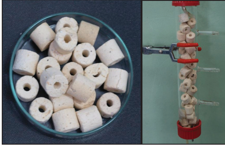
Şekil 3.12. Seramik halka dolgu malzemesi ve deney düzeneği
