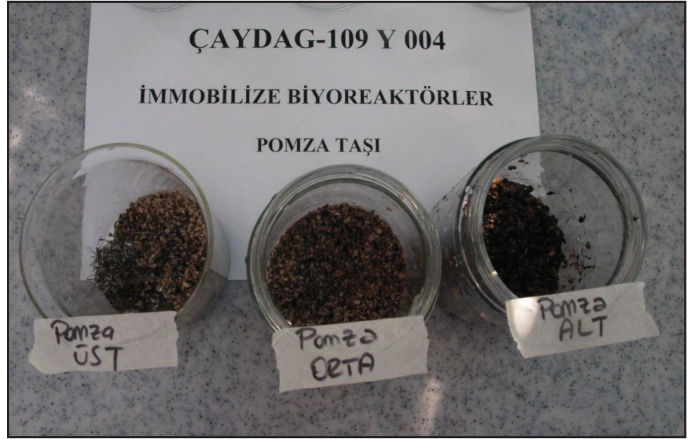
Şekil 3.14. Pomza dolgu materyalinin reaktör içerisinde ayrılması
