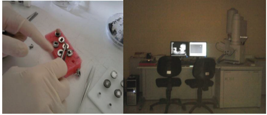
Şekil 3.3. SEM analizi için örneklerin hazırlanması (sol kare) ve Philips XL-30S FEG / FEI Quanta250 FEG marka SEM taramalı elektron mikroskobu (sağ kare)
