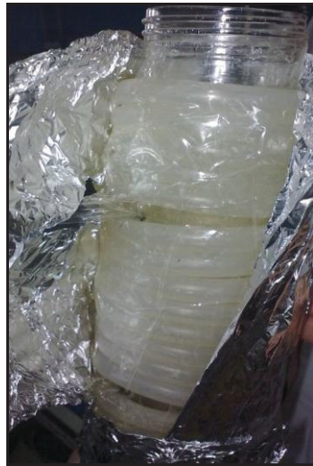
Şekil 3.9. Sirkülatörle yapılmış ısı ceketi
