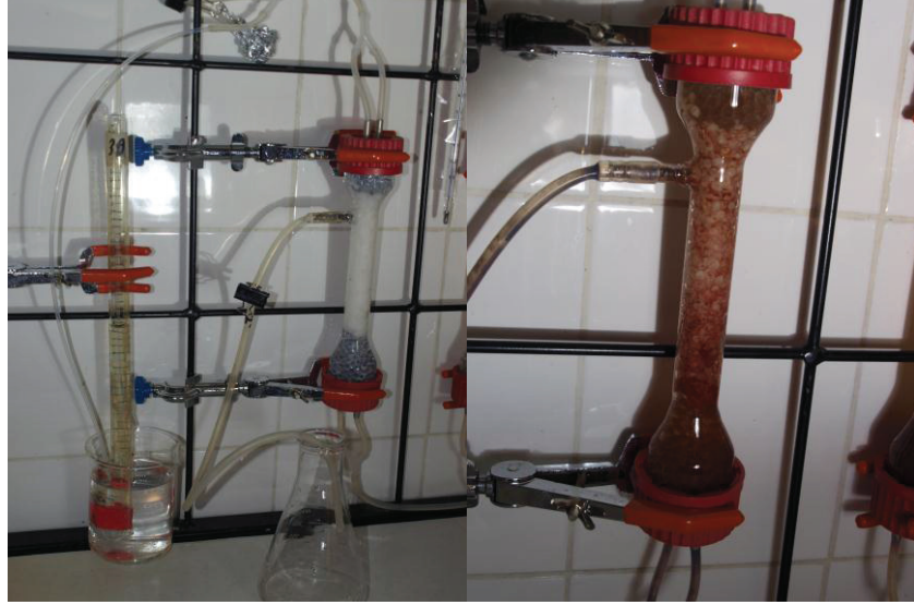
Şekil 4.108. R. Cap. tutuklanmış LentiKat® diski başlangıç ve son görüntüleri
