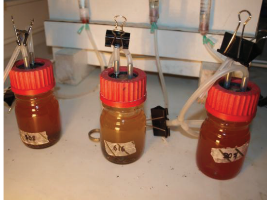
Şekil 4.118. R. Gel.4 ile foto-fermantatif hidrojen üretiminde manyetik parçacıklar içeren reaktörler
