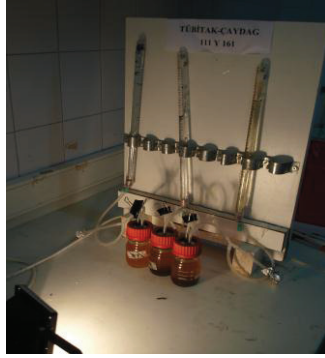
Şekil 4. 113. S.Malt.2 ile foto-fermantatif hidrojen üretiminde manyetik parçacıklar içeren reaktörler
