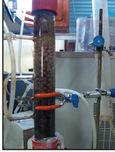
Şekil 4.43. Seramik top dolgulu immobilize reaktörler (sükroz beslemeli)- son görüntüleri
