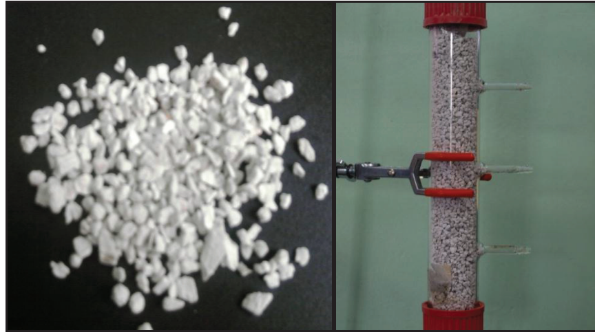
Şekil 3.11. Pomza dolgu malzemesi ve deney düzeneği
