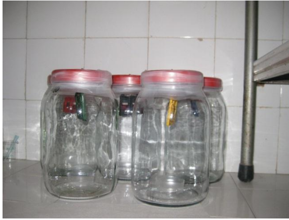
Şekil 3.12 Sıvı ^{226}\text{Ra} standartlı kalibrasyon düzeneği
