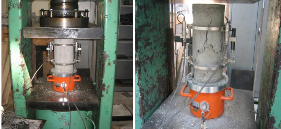
řekil 4.9 : Beton basın deneyi.
