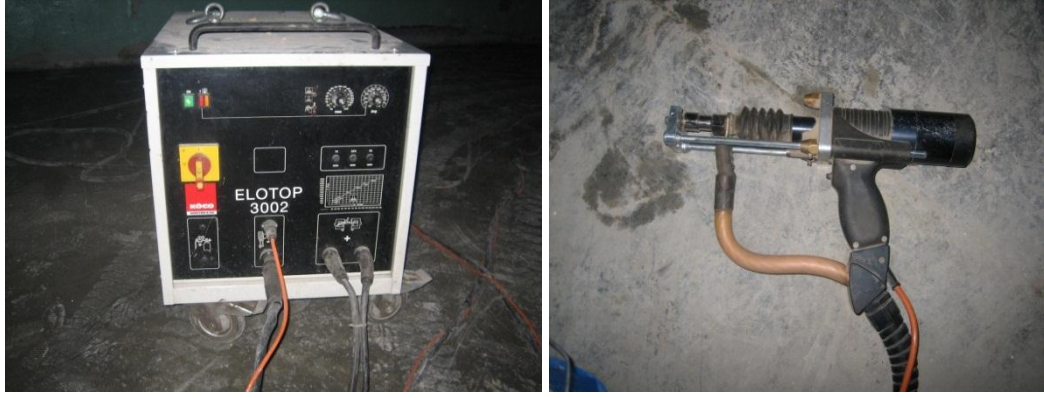
Şekil 4.11 : Saplama kaynak makinesi ve tabancası.
