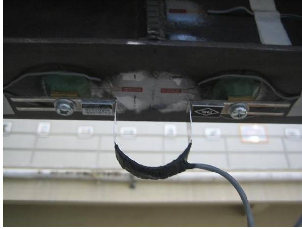
Şekil 4.21 : PI tipi şekil değıştirme ölçerlerin yerleşimi.
