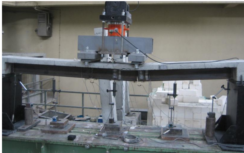
Şekil 5.14 : Fat-01 numunesi yorulma göçmesi.
