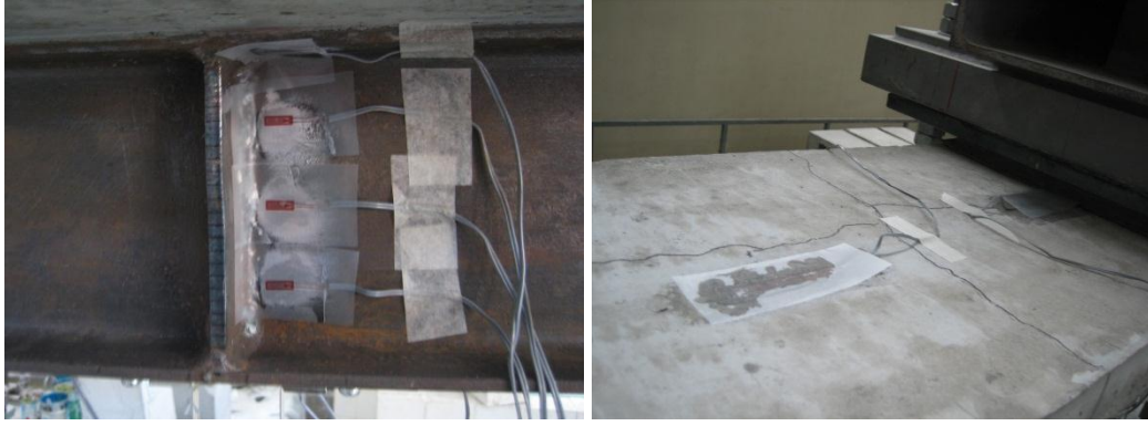
Şekil 4.19 : Çelik ve betonda şekildeğiştirmeölçerlerin yerleşimi.
