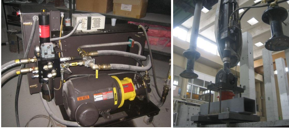
Şekil 4.16 : MTS yük ünitesi ve hidrolik veren.
