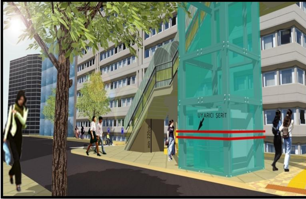
Şekil 6.30 Üst geçit merdiven altı kapatılması uygulanması (Özgün, 2013).
