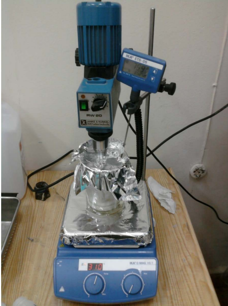
Şekil 3.1. Mikrokürenin hazırlandığı düzenek
