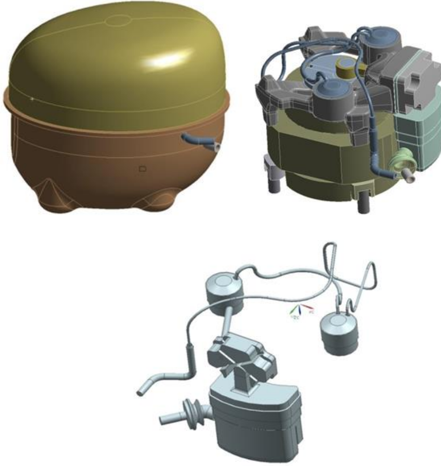
Şekil 4.3 : Kompresör bileşenleri, muhafaza ve akış hattının CAD görünümleri
