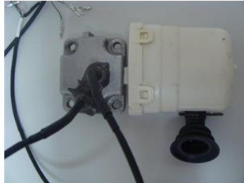
Şekil 3.15 : Emme ve egzoz plenumlarına yerleştirilen basınç sensörleri [15]
