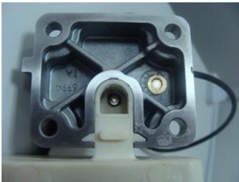
Şekil 3.15 : Emme ve egzoz plenumlarına yerleştirilen basınç sensörleri [15]
