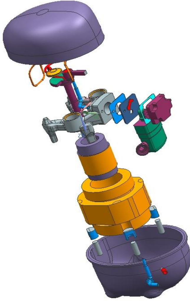
Şekil 4.1 : CFD analizlerinde kullanılan kompresörün parçalanmış katı modeli
