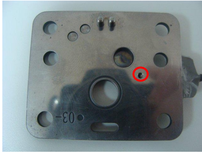
Şekil 3.17 : Silindir basıncı ölçümüne yönelik valf tablasına yerleřtirilen basınç sensörü [15]
