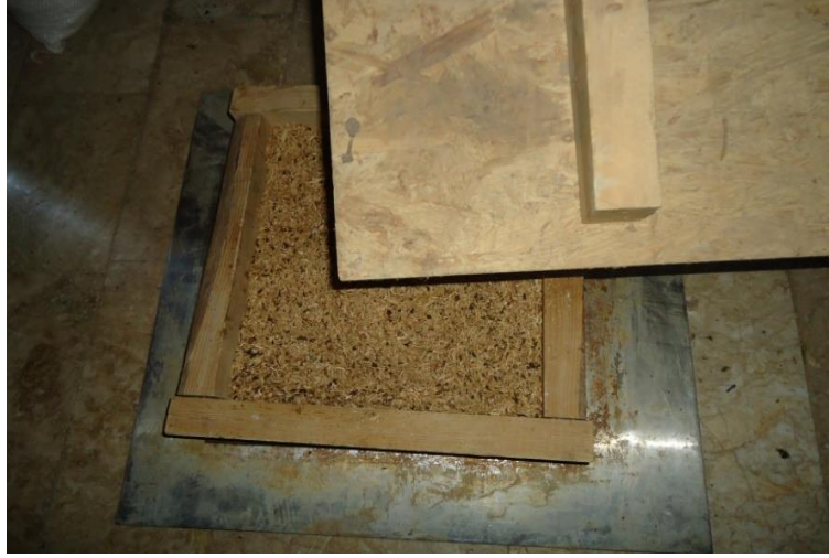
Şekil 3.7. Levha taslağında yongaların sıkıştırılması
