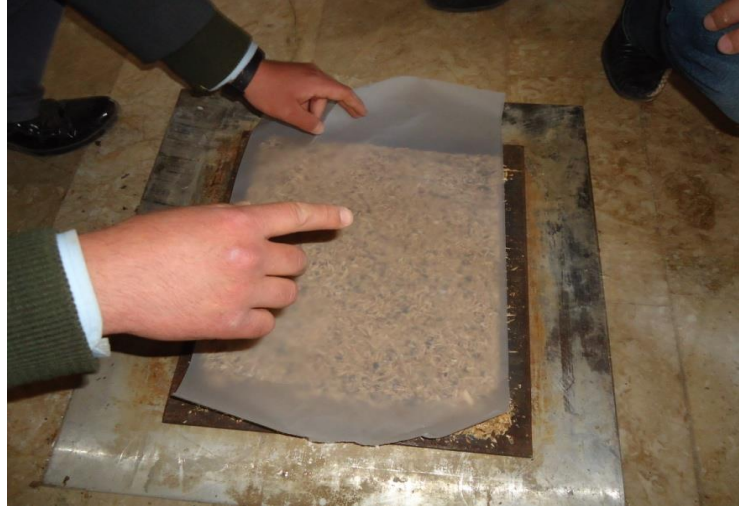
Şekil 3.8. Levha taslağının üzerine pişirme kağıdı serilmesi
