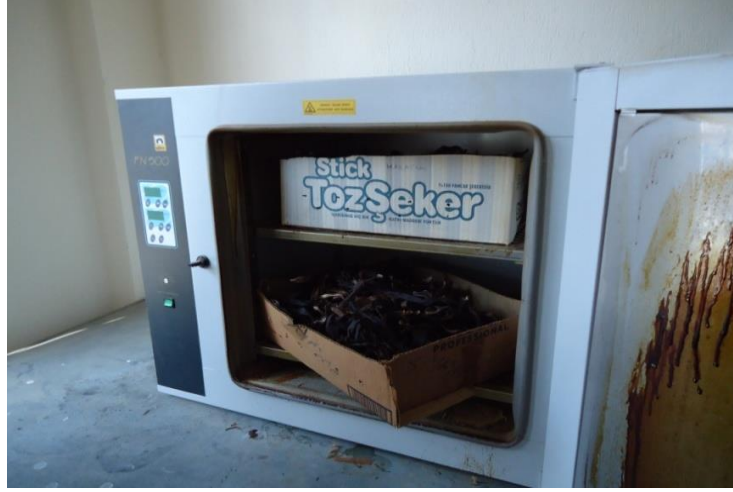
Şekil 3.4. Muz yongalarının etüvde kurutulması
