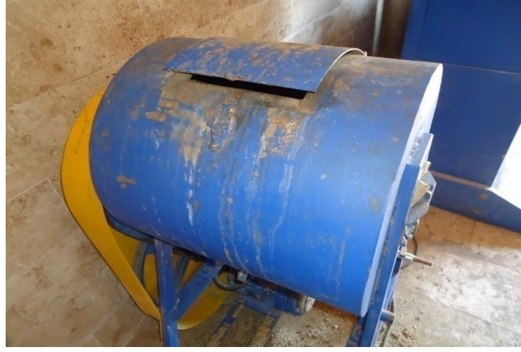
Şekil 3.5. Dört kaşıklı silindir tutkallama makinesi
