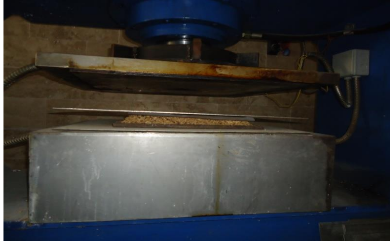
Şekil 3.9. Levha taslağının sıcak prese yerleştirilmesi
