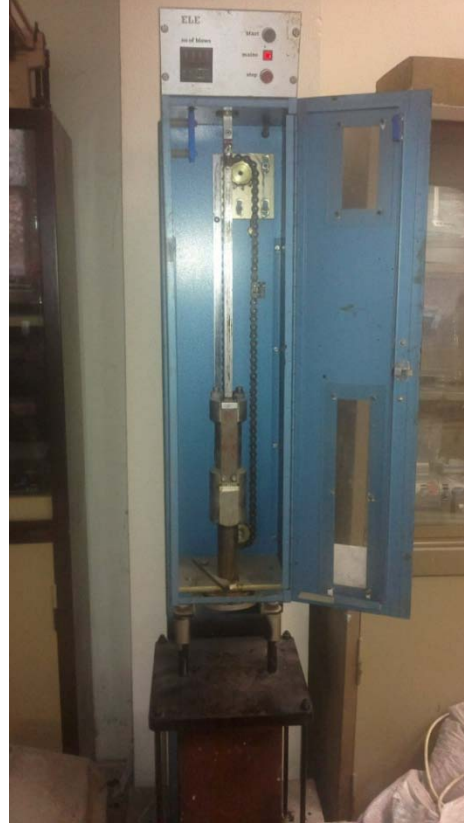
Şekil 6.5 : Deney numunelerini sıkıştırma için kullanılan otomatik tokmak.
