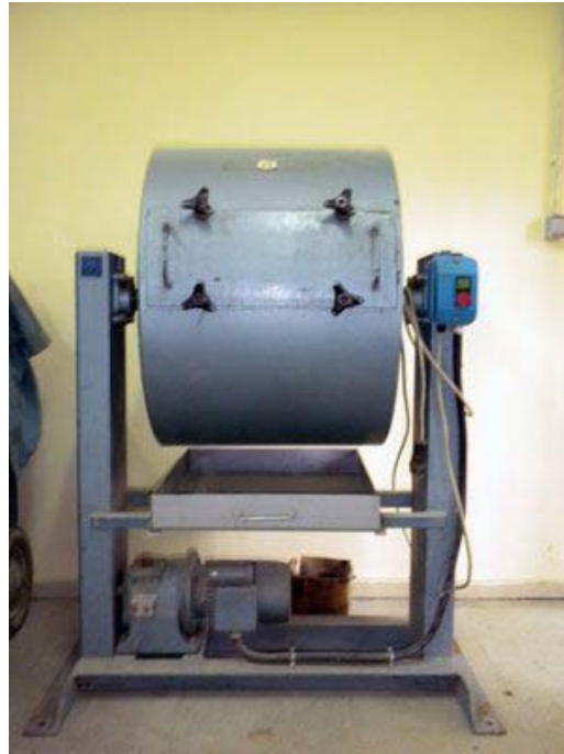
Şekil 6.1 : Los Angeles aşınma deneyinde kullanılan cihaz.
