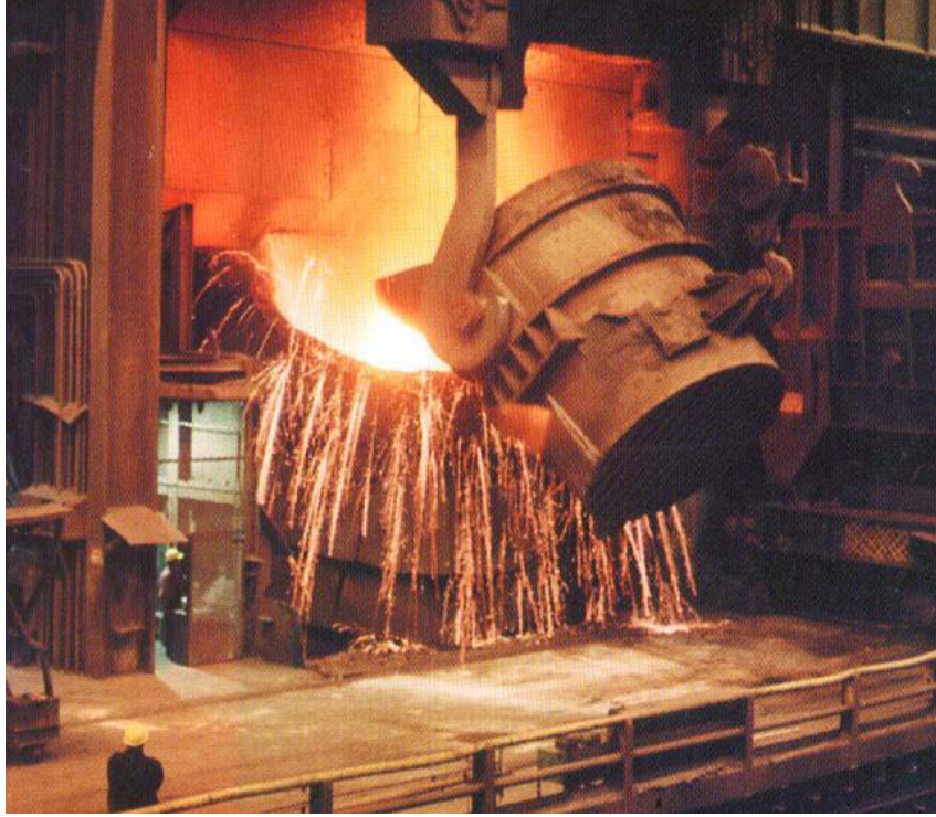
Şekil 4.5 : Yüksek fırından gelen pik demirin BOF'na dökülmesi [17].
