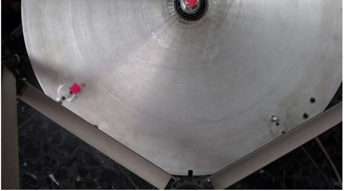
Şekil 3.9 : Görüntü işleme için üstünde işaretleme yapılmış tabla
