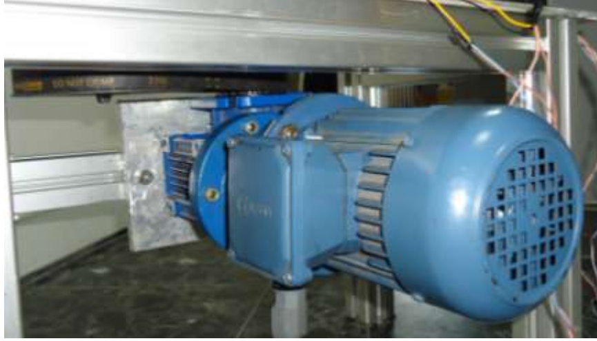
Şekil 2.22 : Elektrik motoru ve kasnak mekanizması
