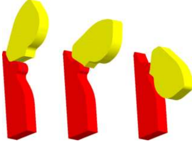
Şekil 1.8 : Parmak hareketlerini taklit edebilecek temas yardımlı esnek mekanizma çalışması[6]
