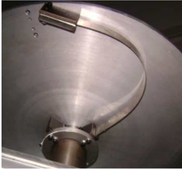
Şekil 2.16 : Esnek elemanın gerilmeye başlamadan önceki sürekli hali
