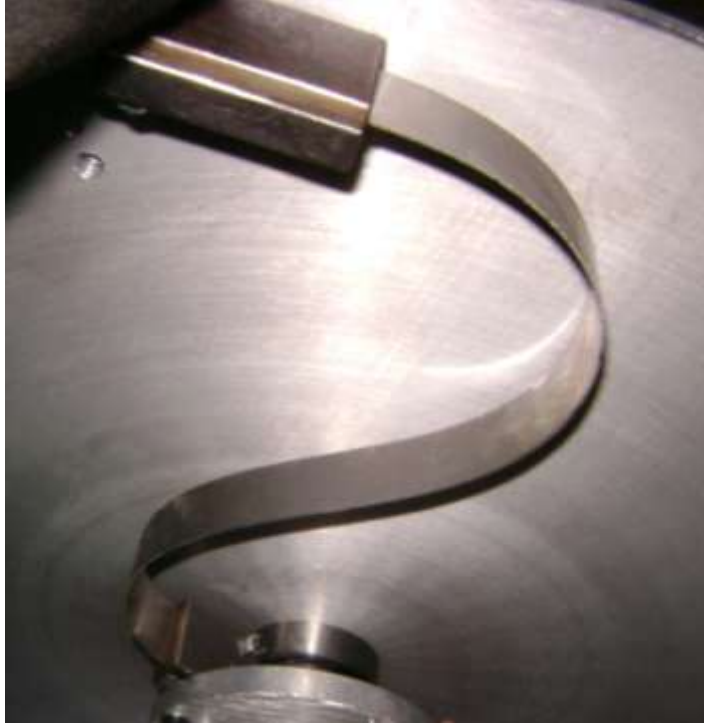
Şekil 2.18 : Esnek elemanın deforme olmuş hali
