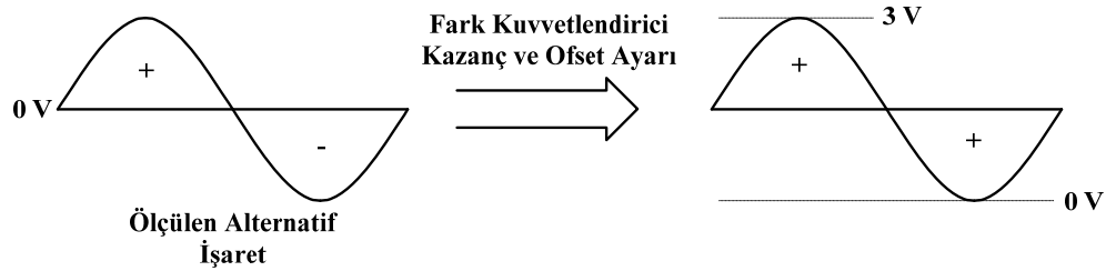
Şekil 4.16 : İki yönlü işaretin analog olarak ölçeklendirilmesi.
