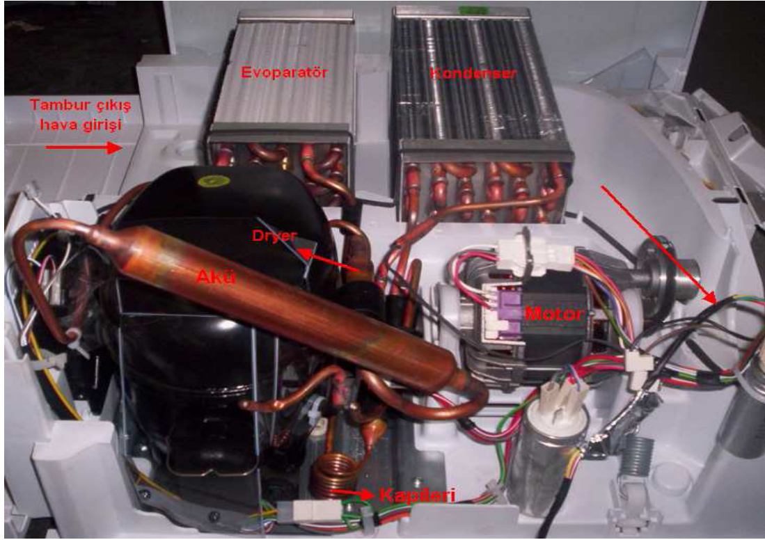
Şekil 3.6 Isı pompası devre elemanları
