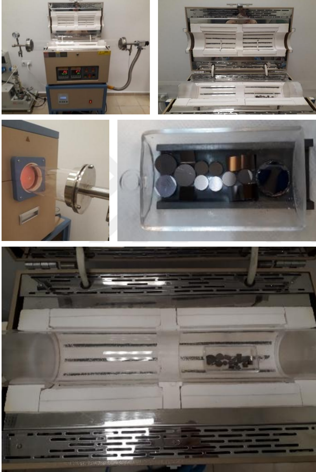
Resim 6.2. Difüzyon fırını ve tavlama aşamasındaki numuneler
