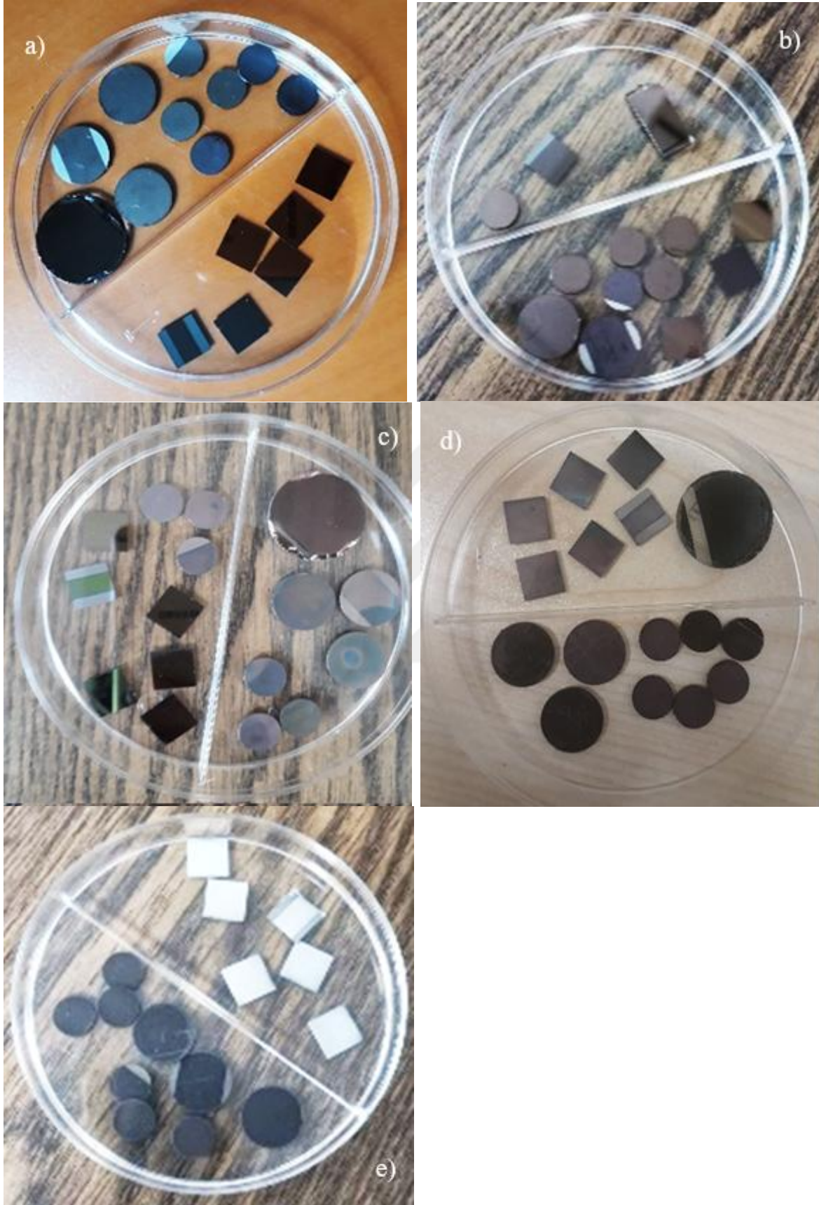
Resim 6.4. Difüzyon fırınında (a) tavlanmayan, (b) 400°C (c) 600°C (d) 800°C (e) 1000°C'de tavlanan numunelerin görüntüleri
