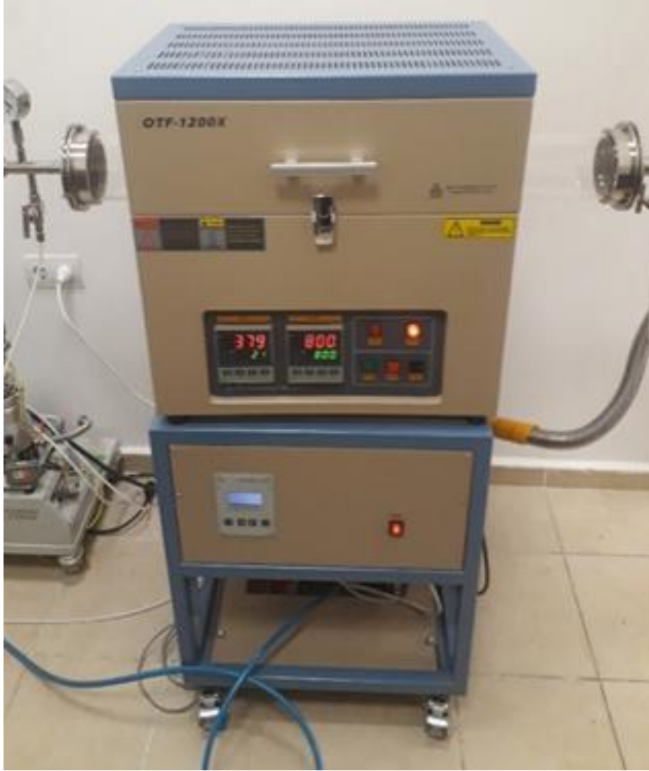
Resim 6.3. \text{TiO}_x\text{N}_y 'nin 400^\circ\text{C} , 600^\circ\text{C} , 800^\circ\text{C} ve 1000^\circ\text{C} 'de tavlandığı difüzyon fırını
