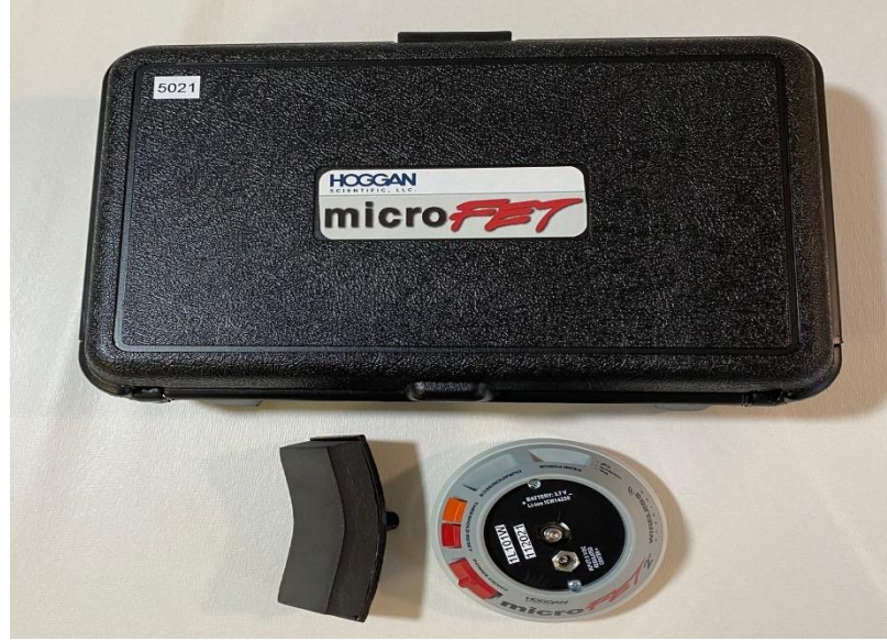
Şekil 22. Micro Fet2 Dijital El Dinamometresi
