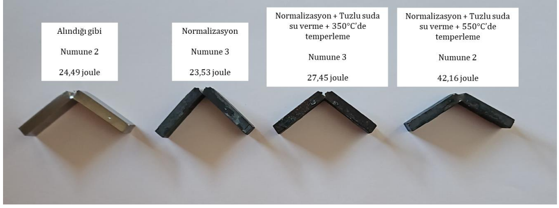
Şekil 5. 1. Bazı çentik darbe numunelerinin deney sonrası genel görünüşleri ve sonuçları
