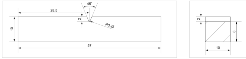
Şekil 4. 23. Charpy çentik darbe deneyi numunelerinin teknik resmi
