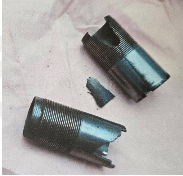
Şekil 2. 28. Yanlış ısıtıl işlem kaynaklı hasar alan mobil şoklar (Yıldız Silah izniyle)
