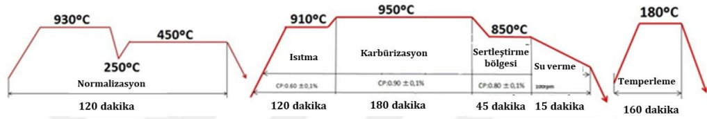
Şekil 3.3. AISI 8620 çeliğine uygulanmış örnek bir ısıtım işlem prosedürü (Neto vd., 2018)
