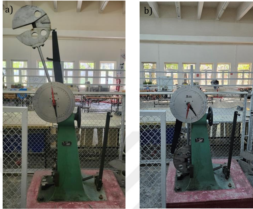
Şekil 4. 2. Testlerde kullanılan Charpy çentik darbe test cihazı a) deneye hazır halinden fotoğraf, b) deney sonundan fotoğraf
