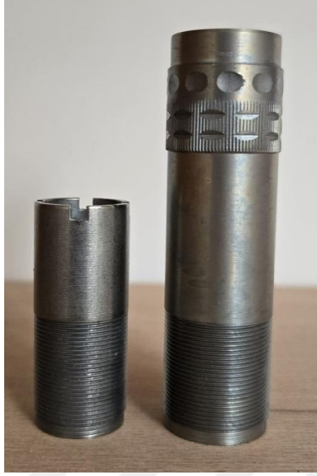
Şekil 2. 19. Normal ve uzatma mobil şok örnekleri (Yıldız Silah izniyle)
