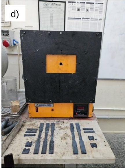
Şekil 4. 15. Uygulanan ısıt işlem prosesinden görseller: a) fırının sıcak haldeki görünüşü, b) fırın içinde numunelerin görünüşü, c) fırında temperleme sıcaklığı, d) fırından çıkarılıp soğumaya bırakılmış numuneler (Devam)
