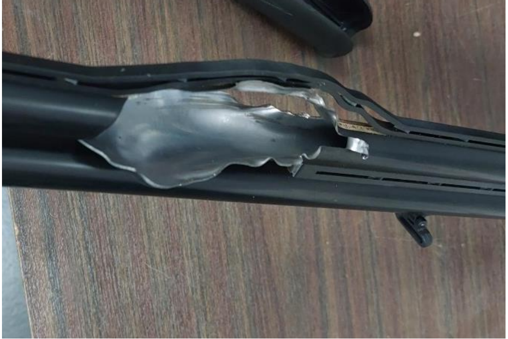
Şekil 2. 24. Hasara uğramış namlu örneęi (Yıldız Silah izniyle)
