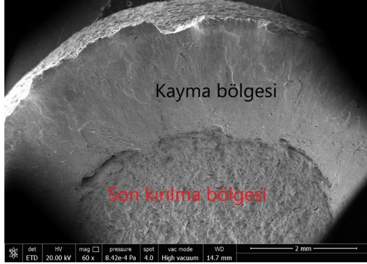
Şekil 5. 31. 275 °C'de temperlenmiş çekme numunesi; Akma dayanımı: 1161 MPa, Çekme dayanımı: 1522 MPa, Kopma Uzaması: %24,7
