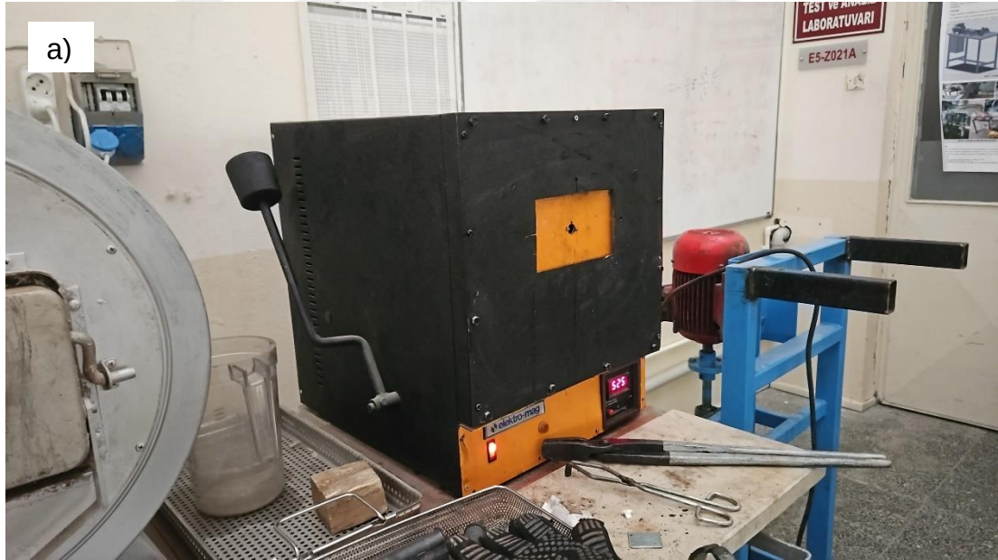
Şekil 4. 22. Isıt işlem uygulamalarından fotoğraflar; a)Temperleme aşaması, b)Sertleştirme aşaması, c)Normalizasyon aşaması, d) Fırının içinden bir görünüş
