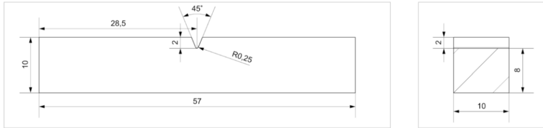
Şekil 4. 16. Charpy çentik darbe test numunelerinin teknik resmi
