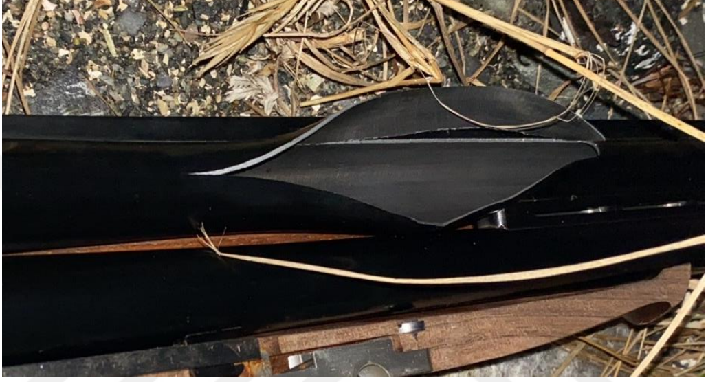
Şekil 2. 23. Hasara uğramış namlu örneęi (Yıldız Silah izniyle)
