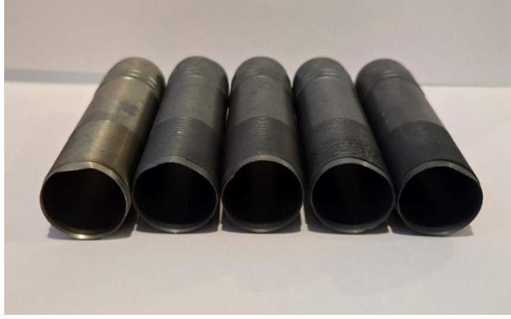
Şekil 2. 27. Yanlış ısıtıl işlem kaynaklı hasar alan mobil şoklar (Yıldız Silah izniyle)
