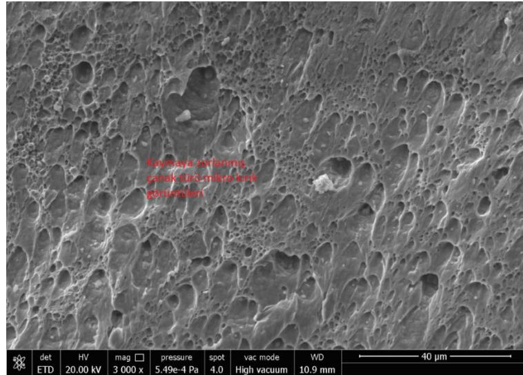
Şekil 5. 36. 425 °C’de temperlenmiş darbe testi numunesi, darbe dayanım değeri: 55,16 J/cm 2
