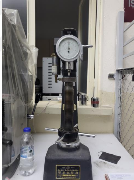
Şekil 4. 1. Sertlik ölçümlerinde kullanılan Rockwell sertlik ölçüm cihazı
