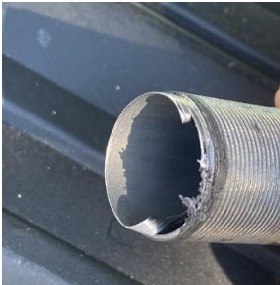
řekil 2. 26. İmalat hatası kaynaklı hasarlı mobil řok (Yıldız Silah izniyle)
