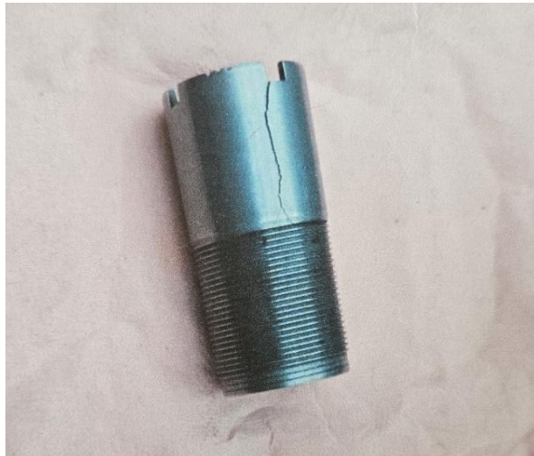
Şekil 2. 29. Yanlış ısıtıl işlem kaynaklı hasar alan mobil şok (Yıldız Silah izniyle)
