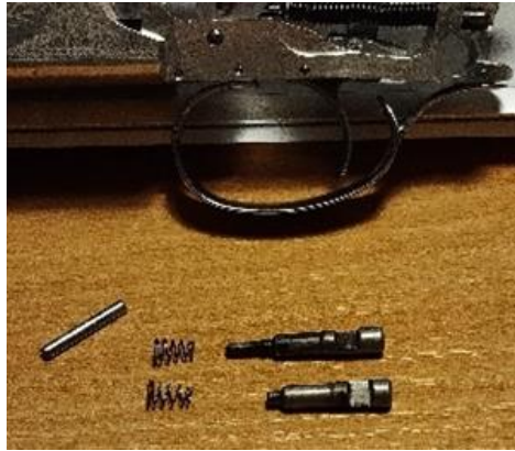
Şekil 2. 31. Isıl işlem kaynaklı hasar alan ateşleme iğnesi (Yıldız Silah izniyle)
