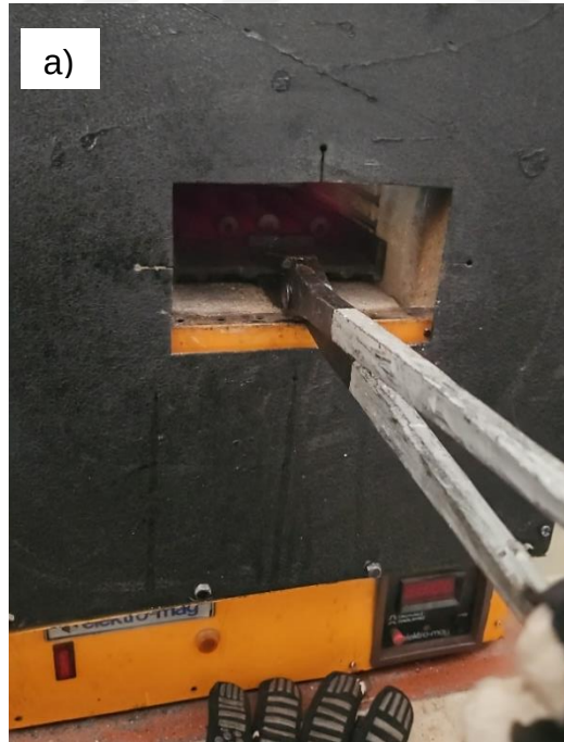
Şekil 4. 29. Isıl işlemlerden fotoğraflar; a)Temperleme işlemi, b)Sertleştirme işlemi, c)Su verme işlemi esnasından genel görünüşler
