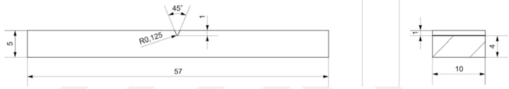
Şekil 4. 10. Charpy çentik darbe test numunelerinin teknik resmi
