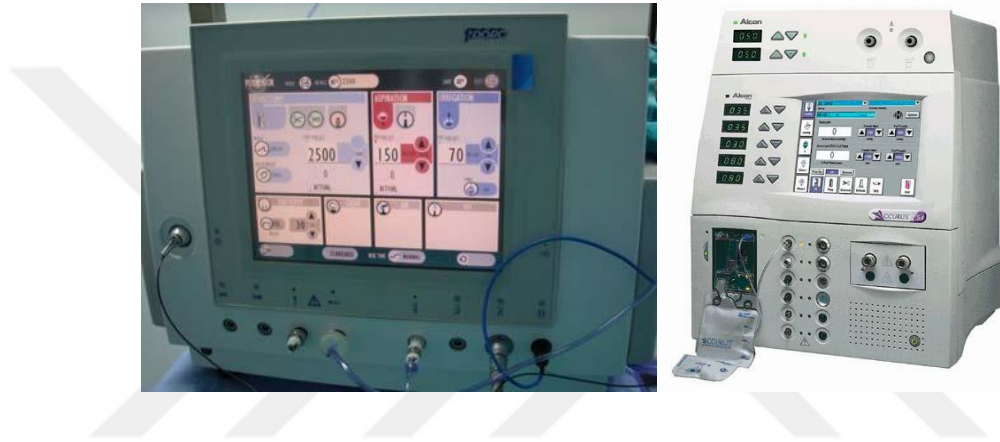
Şekil 9: Vitrektomi cihazları (solda Dorc vitrektomi cihazı ,sağda Alcon Accurus vitrektomi cihazı ) (39).
