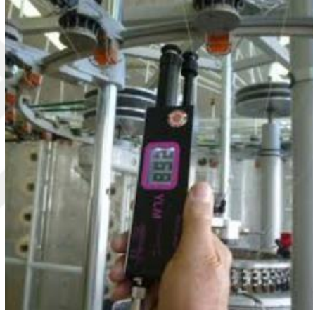
Şekil 1.42 Makine Üzerinde İplik Uzunluğu Ölçümü
