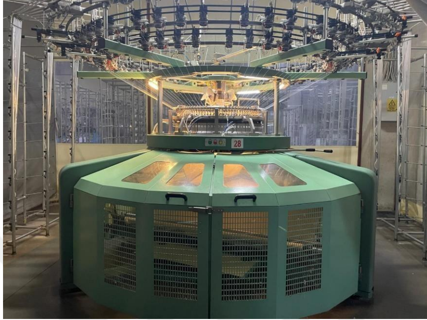
Şekil 2.3 Çalışmada Kullanılan Tek Plaka Yuvarlak Örgü Makinesi
