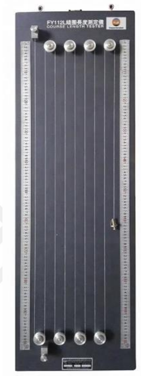
Şekil 1.43 İplik Uzunluğu Ölçümü İçin Kullanılan Hatra
