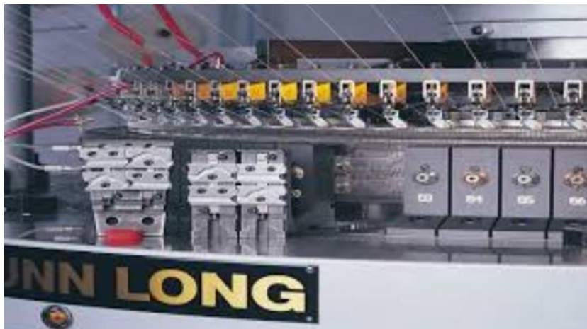
Şekil 1.23 Yuvarlak Örgü Makinesi Kilit Tertibatı
