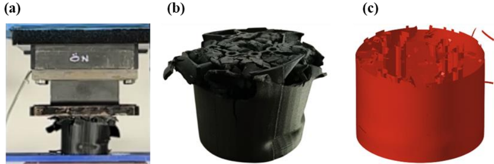
Şekil 4. 19. CF15PET malzemeli ikinci tasarım çarpışma kutusu (a) test görseli, (b) test sonrası görsel, (c) simülasyon sonrası görseli
