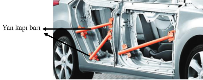
Şekil 2. 4. Yan kapı barlarının araç üzerindeki konumu(M. F. Li vd., 2014)
