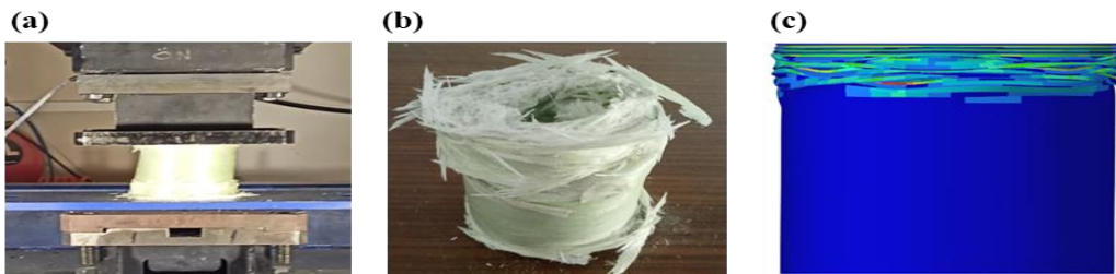
Şekil 4. 35. G2 kompozit çarpışma kutusu (a) test görseli, (b) test sonrası görsel, (c) simülasyon sonrası görsel
