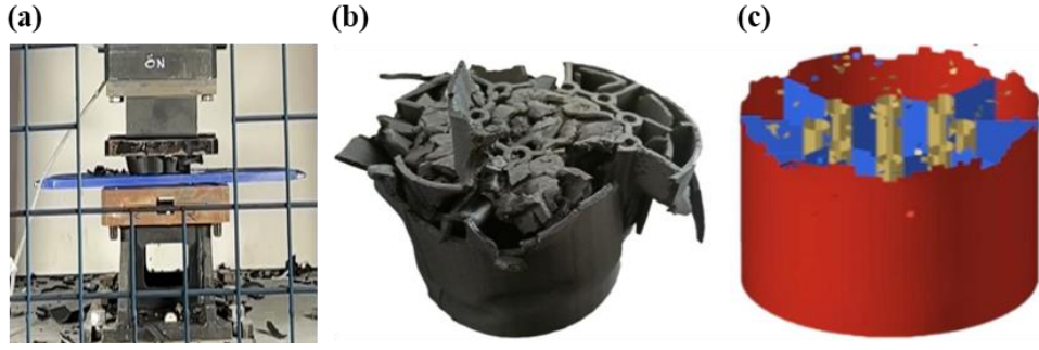
Şekil 4. 11. CF15PET malzemeli birinci tasarım çarpışma kutusu (a) test görseli, (b) test sonrası görsel, (c) simülasyon sonrası görsel
