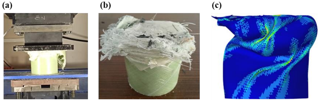
Şekil 4. 31. G1A kompozit çarpışma kutusu (a) test görseli, (b) test sonrası görsel, (c) simülasyon sonrası görseli
