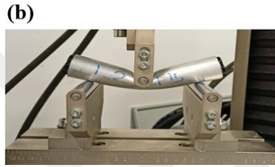
řekil 4. 73. SYC kodlu yan kapı barının (a) kuvvet- yer deęiřtirme grafięi, (b) test sonrası görüntü, (c) simülasyon sonrası görüntü
