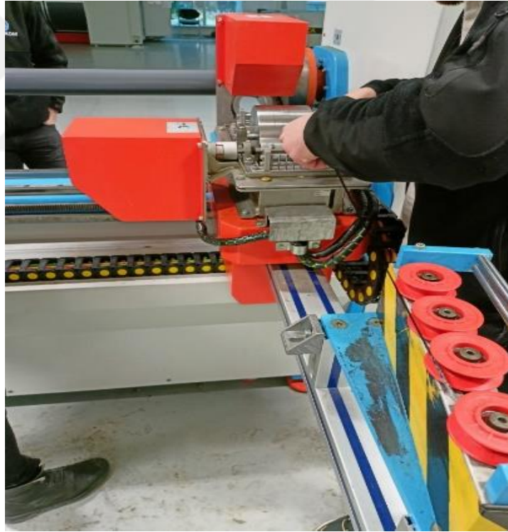
Şekil 3. 10. Filamentlerin reçine havuzundan geçirilmesi
