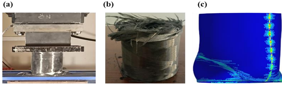
Şekil 4. 51. C2P kompozit çarpışma kutusu (a) test görseli, (b) test sonrası görsel, (c) simülasyon sonrası görseli
