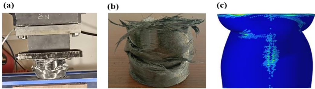
Şekil 4. 49. C2A kompozit çarpışma kutusu (a) test görseli, (b) test sonrası görsel, (c) simülasyon sonrası görsel
