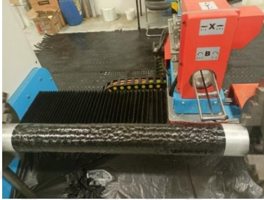
Şekil 3. 11. Kompozit çarpışma kutularının üretilmesi
