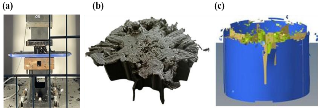
Şekil 4. 9. PLA malzemeli birinci tasarım çarpışma kutusu a.) test görseli, b.) test sonrası görsel, c.) simülasyon sonrası görseli
