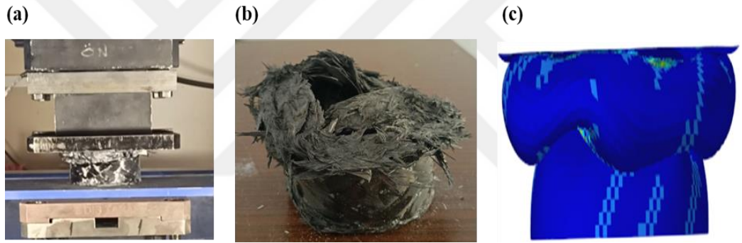
Şekil 4. 41. C1 kompozit çarpışma kutusu (a) test görseli, (b) test sonrası görsel, (c) simülasyon sonrası görseli
