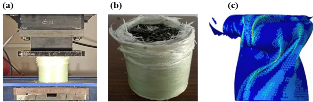
Şekil 4. 39. G2P kompozit çarpışma kutusu (a) test görseli, (b) test sonrası görsel, (c) simülasyon sonrası görseli
