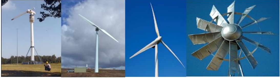
Şekil 2.7 : Rüzgar türbinlerinde kanat sayıları.
