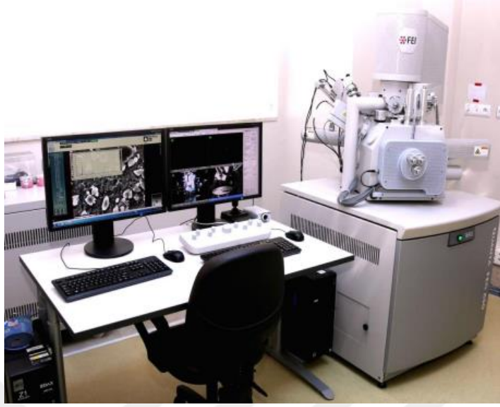
Şekil 3.29. FEI Quanta 650 Field Emission SEM - Alan Taramalı Elektron Mikroskobu (FE-SEM)
