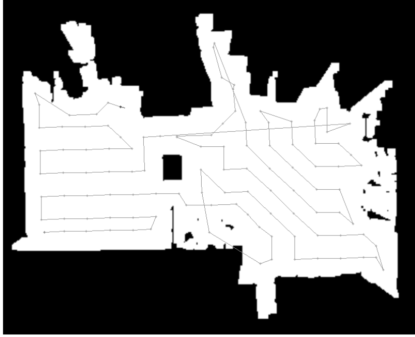
Şekil 3.15. Enerji Fonksiyonel Optimizasyonu ile Kapsama Yol Planlama Algoritması Atölye Ortamı Yol Planı
