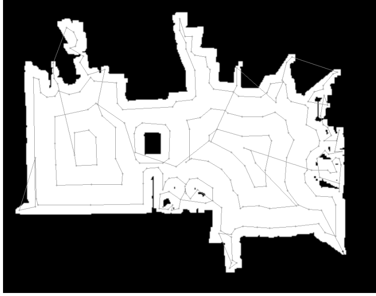
Şekil 3.18. Ortalama Kayma Kümeleme Yöntemi ile Kapsama Yol Planlama Algoritması Atölye Ortamı Yol Planı
