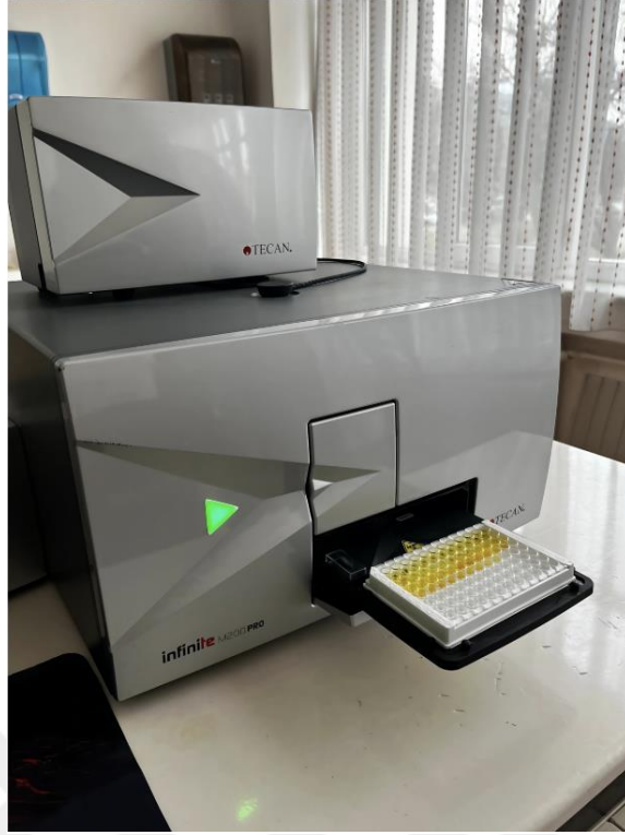
Resim 3.8. BCL-2 kitinin plaka okuyucuya (Tecan, Infinite 200 PRO) yerleştirilmesi
