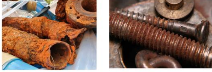
Şekil 2.11. Genel korozyon örneği
