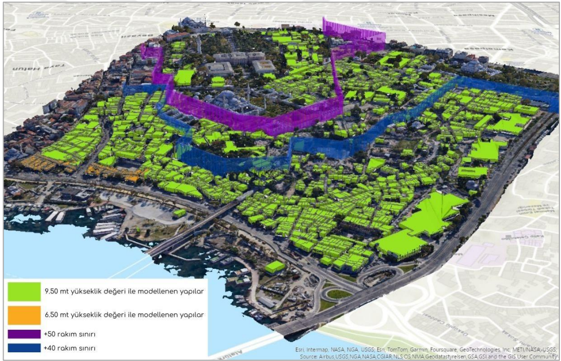
Şekil 4.9 : Meri 1/1000 Ölçekli Koruma Amaçlı Uygulama İmar Planında yer alan çalışma alanına ilişkin yapı yükseklik sınırlamaları modeli.
